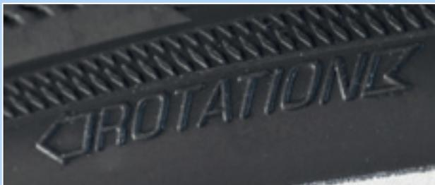
Abbildung 68: Laufrichtungspfeil
