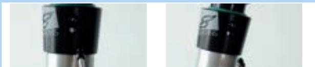
Abbildung 206: Außenhülse befestigen
