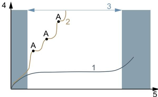
Abbildung 157: Diagramm Verschleiß, Betriebsdauer (x) zu Werstoffabtrag (y)
