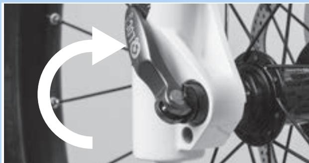
Abbildung 83: Schnellspanner schließen
