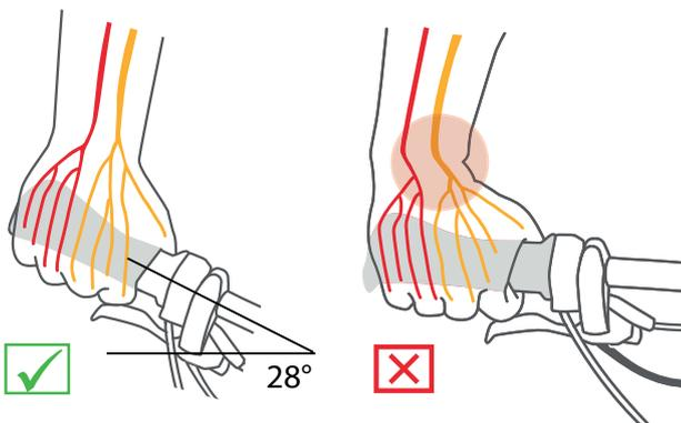
Abbildung 97: Verlauf der Nerven bei gebogenem und geradem Lenker
