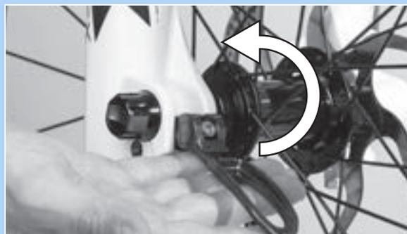
Abbildung 77: Schnellspannhebel in Pfeilrichtung drücken
