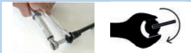
Abbildung 195: Im Uhrzeigersinn einstellen
