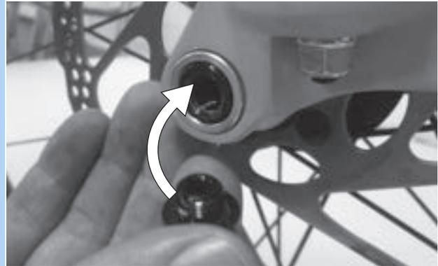
Abbildung 72: Sicherungsschraube einsetzen
