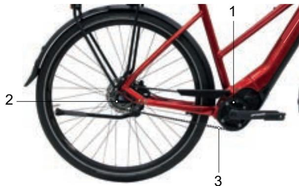
Abbildung 35: Schema Riemenantrieb
