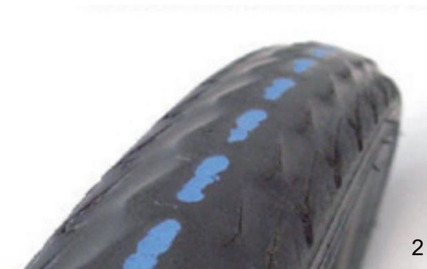
Abbildung 161: Reifen ohne Profil, der gewechselt werden kann (1), und Reifen mit durchscheinendem Pannenschutz (2), der gewechselt werden muss
