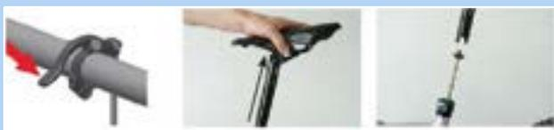
Abbildung 174: Sattelstütze herausziehen
