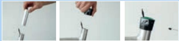
Abbildung 197: Gleitbuchse und Außenhülse einbauen
