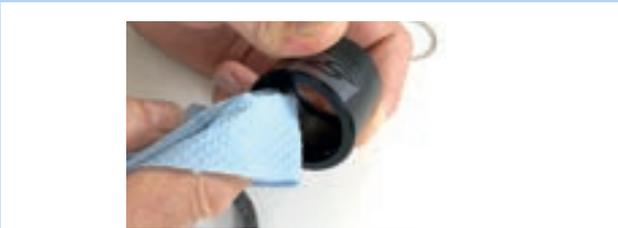
Abbildung 220: Außenhülse reinigen
