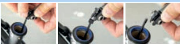
Abbildung 214: Bowdenzug entfernen
