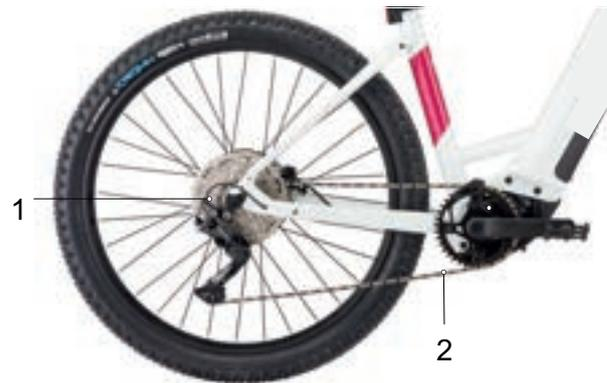
Abbildung 34: Schema Kettenantrieb mit Kettenschaltung
