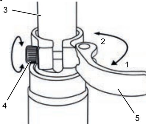
Abbildung 91: Schnellsprenger der Sattelstütze öffnen
