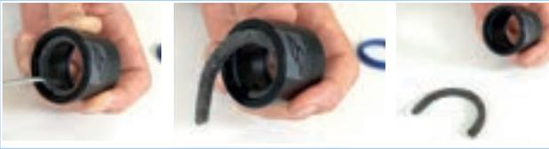
Abbildung 219: Filzring entfernen
