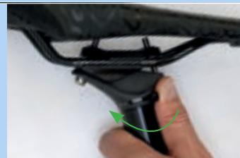
Abbildung 229: Höhenverstellung schließen
