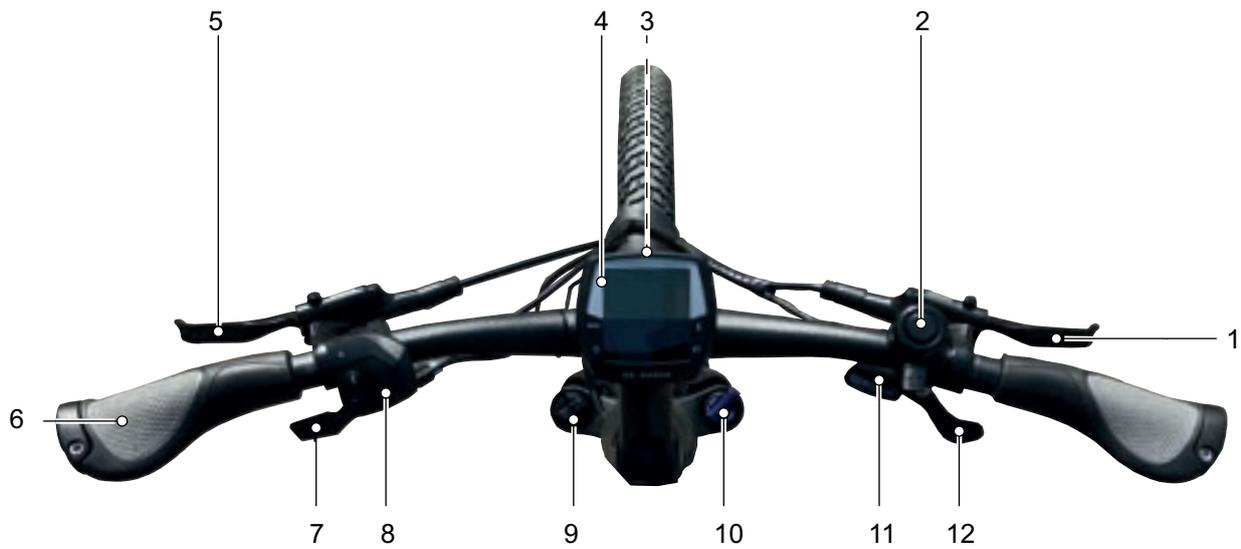
Abbildung 30: Detailansicht Lenker mit BOSCH Intuvia Bordcomputer, Beispiel
