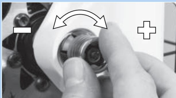
Abbildung 82: Spannung einstellen
