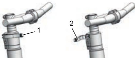
Abbildung 98: Geschlossener (1) und geöffneter (2) Vorbau-Spannhebel, Beispiel All Up
