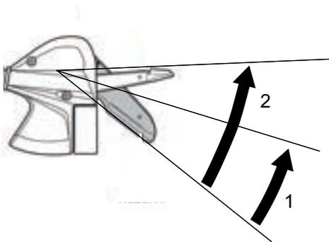
Abbildung 135: Schalten mit Hebel A, Beispiel Schaltung SL-M315
