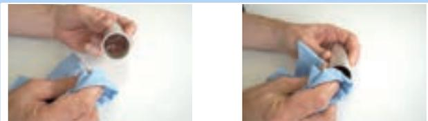
Abbildung 188: Gleitbuchsenrohr reinigen
