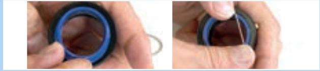
Abbildung 222: Abstreifer einlegen und befestigen
