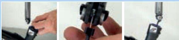
Abbildung 231: Sattelstütze aufhängen und einschieben
