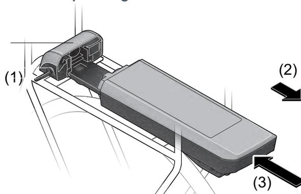
Abbildung 134: Gepäckträgerakku herausnehmen (2) und einsetzen (3)
