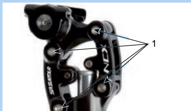
Abbildung 172: Schmierpunkte SR Suntour Feder-Sattelstütze
