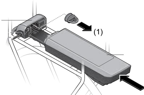
Abbildung 137: Offene Kontakte mit Abdeckklappe abdecken, Beispiel Gepäckträger
