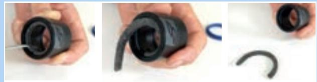
Abbildung 184: Filzring entfernen
