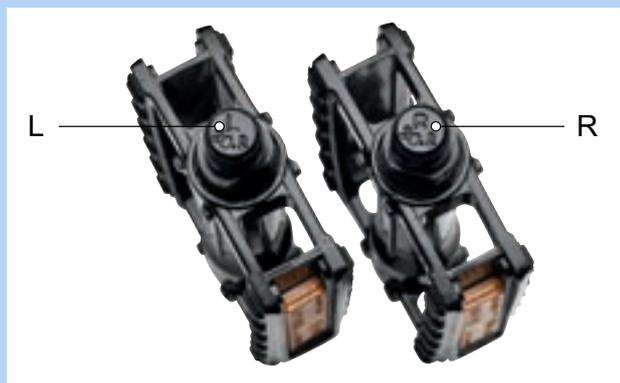
Abbildung 84: Beispiel Kennzeichnung von Pedalen
