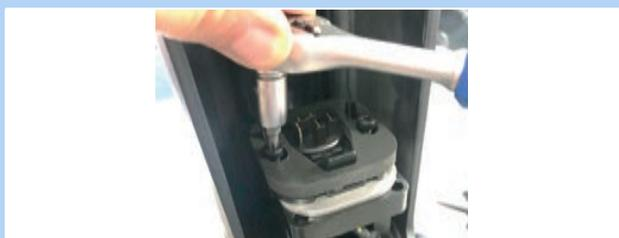
Abbildung 55: Akkuhalter Schrauben lösen
