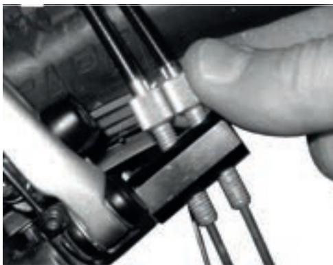
Abbildung 166: ROHLOFF-Naben Versionen mit interner Schaltansteuerung haben die Zugeinsteller am Zuggegenhalter
