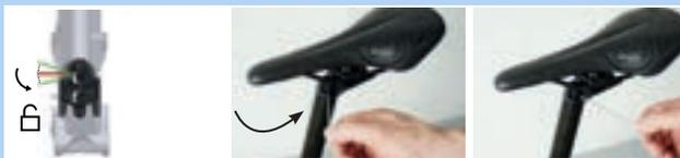
Abbildung 173: Höhenverstellungsbetätigung in „Geöffnete Stellung“ bringen
