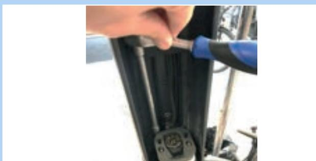
Abbildung 57: Innensechskant-Schrauben entfernen
