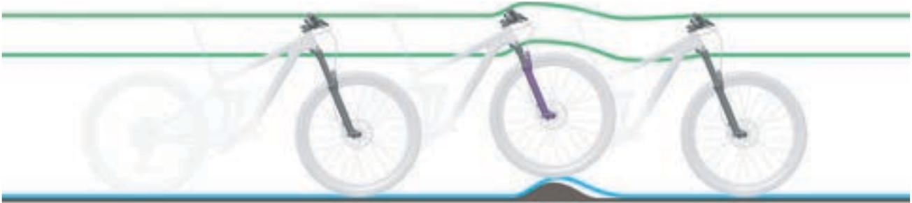
Abbildung 241: Zu harte Dämpfung der Federgabel bei Unebenheiten
