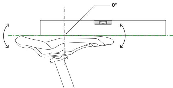
Abbildung 95: Waagerechte Sattelneigung mit 0° Neigung in der Sattelmitte
