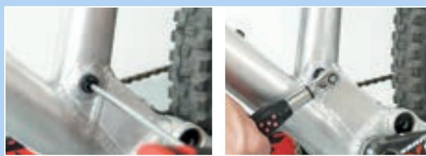
Abbildung 234: Sattelstütze festschrauben
