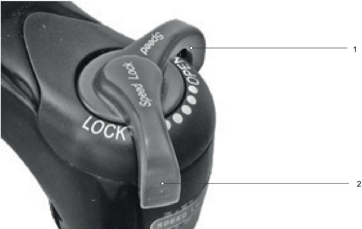
Abbildung 142: Suntour-Druckstufendämpfer in offener (1) und geschlossener (2) Position
