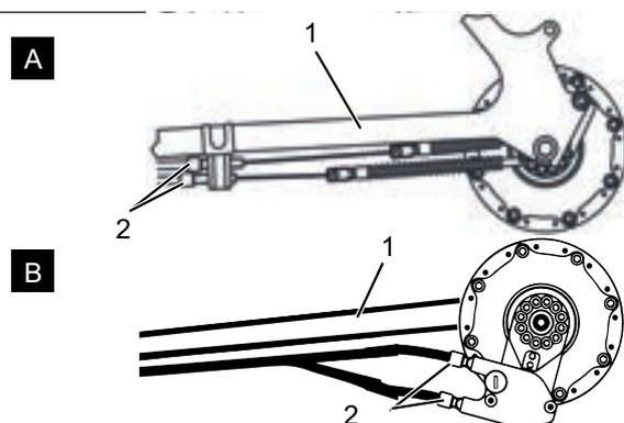
Abbildung 168: Einstellhülsen (2) an zwei alternativen Ausführungen (A und B) einer zweizügigen, seilzugbetätigten Gangschaltung an der Kettenstrebe (1)
