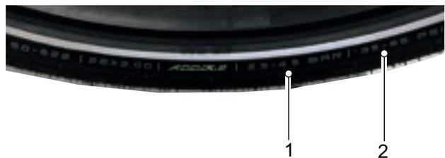
Abbildung 160: Fülldruck in bar (1) und psi (2)
