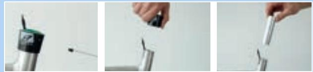
Abbildung 215: Außenhülse und Gleitbuchse ausbauen
