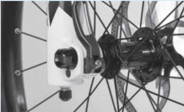
Abbildung 170: Spannkraft des Schnellspanners einstellen
