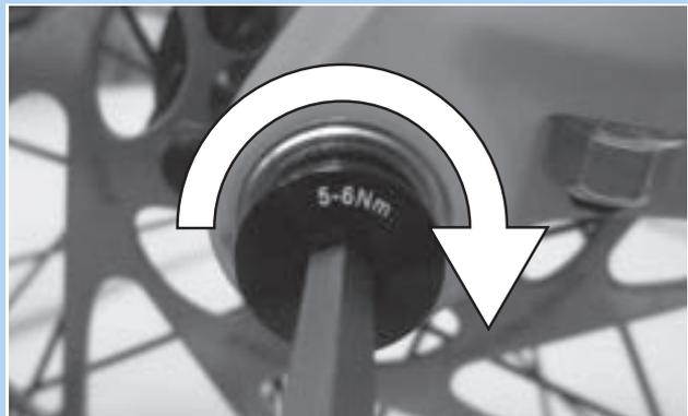
Abbildung 73: Sicherungsschraube anziehen
