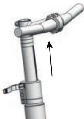
Abbildung 99: Sicherungshebel nach oben ziehen, Beispiel All Up
