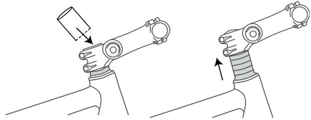
Abbildung 101: Ahead-Vorbau durch Einbau von Distanzringe (Spacer) erhöhen
