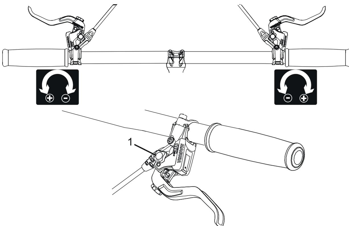
Abbildung 110: Benutzung des Drehknopfs (1) zur Druckpunkt-Einstellung
