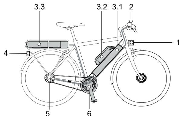
Abbildung 36: Schema elektrisches Antriebssystem mit elektrischen Bauteilen
