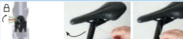
Abbildung 210: Höhenverstellung schließen
