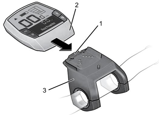
Abbildung 81: Bordcomputer (2) über die Arretierung des Bordcomputers (1) bis zum Anschlag der Halterung (3) schieben
