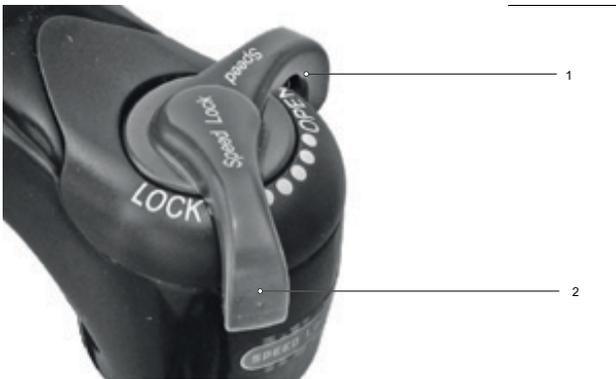
Abbildung 242: Druckstufeneinsteller weicher einstellen
