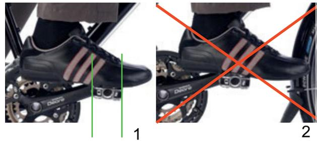
Abbildung 132: Korrekte (1) und falsche (2) Fußposition auf dem Pedal
