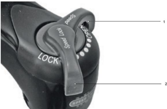
Abbildung 240: Druckstufeneinsteller härter einstellen
