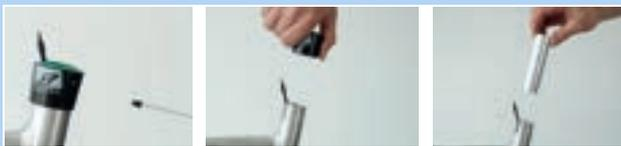
Abbildung 181: Außenhülse und Gleitbuchse ausbauen
