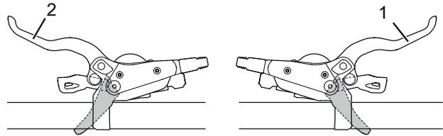
Abbildung 172: Bremshebel hinten (1) und vorne (2), Beispiel SHIMANO Bremse
