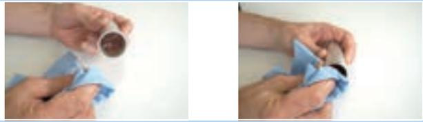
Abbildung 223: Gleitbuchsenrohr reinigen
