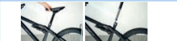
Abbildung 213: Sattelstütze entfernen
