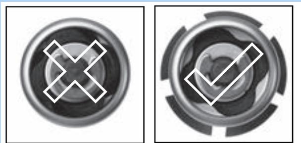
Abbildung 80: Geschlossener und geöffneter Flansch
