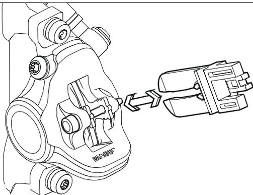
Abbildung 54: Transportsicherung befestigen
