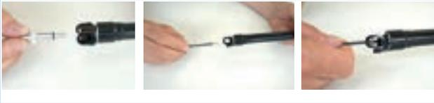
Abbildung 196: Kartusche Ventildeckel befestigen
