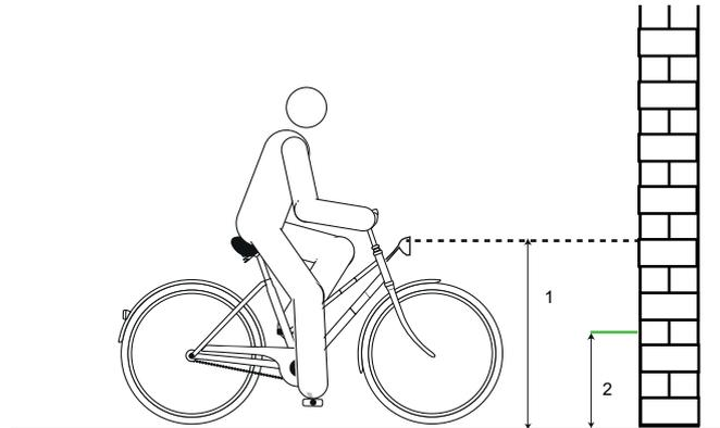
Abbildung 123: Frontleuchtehöhe (1) und die halbe Scheinweferhöhe (2)
