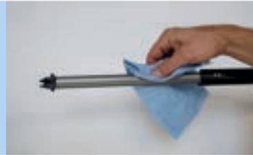
Abbildung 226: Längsführungsnut reinigen
