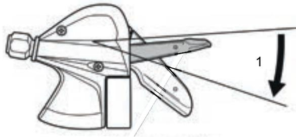
Abbildung 136: Schalten mit Hebel B, Beispiel Schaltung SL-M315
