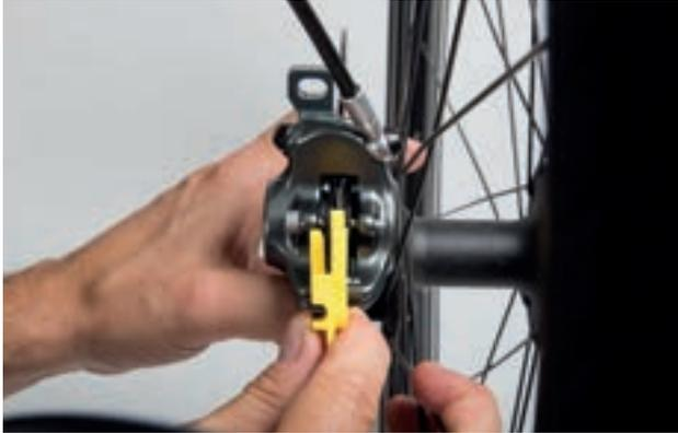
Abbildung 163: Bremsbelag im eingebauten Zustand mithilfe der Transportsicherung prüfen
