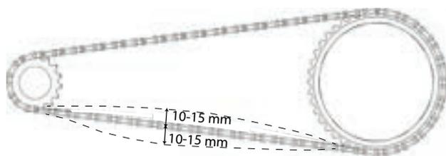
Abbildung 165: Kettenspannung prüfen
