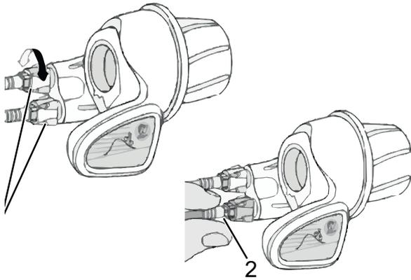
Abbildung 169: Drehgriffschalter mit Einstellhülsen (1) und Spiel der Gangschaltung (2)
