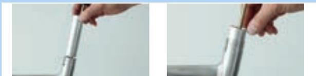
Abbildung 204: Gleitbuchsenrohr ins Sattelrohr stecken
