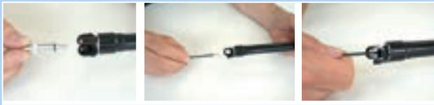
Abbildung 192: Kartusche Ventildeckel befestigen
