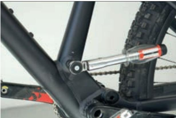
Abbildung 89: Sattelstützen-Achse anziehen
