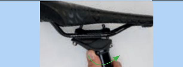
Abbildung 224: Höhenverstellung öffnen
