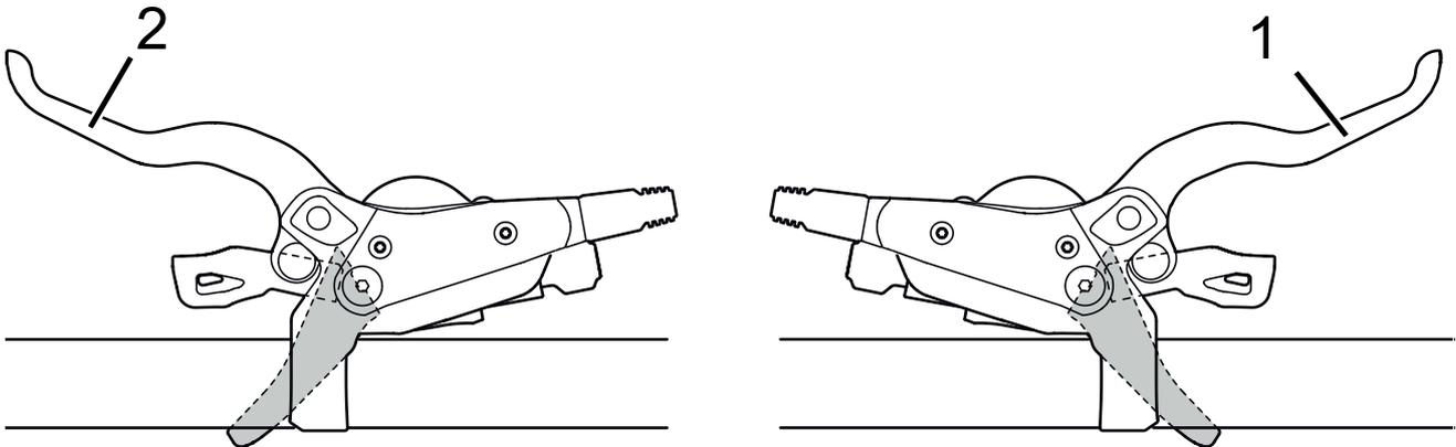
Abbildung 49: Handbremse Hinterrad (1) und Vorderrad (2), Beispiel SHIMANO Bremse
