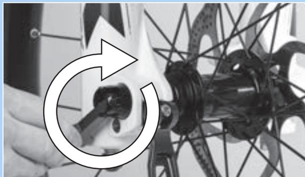
Abbildung 75: Achse in Pfeilrichtung anziehen
