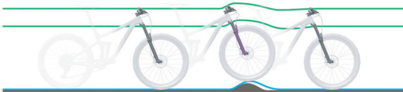
Obr. 76: Příliš tvrdé tlumení odpružené vidlice u nerovnosti
