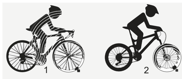
Obr. 4: Pedelec bez odpružení (1) a s odpružením (2)
