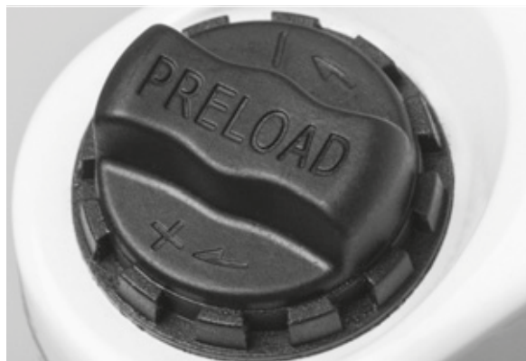
Obr. 40: Nastavovací kolečko SAG na korunce odpružené vidlice
