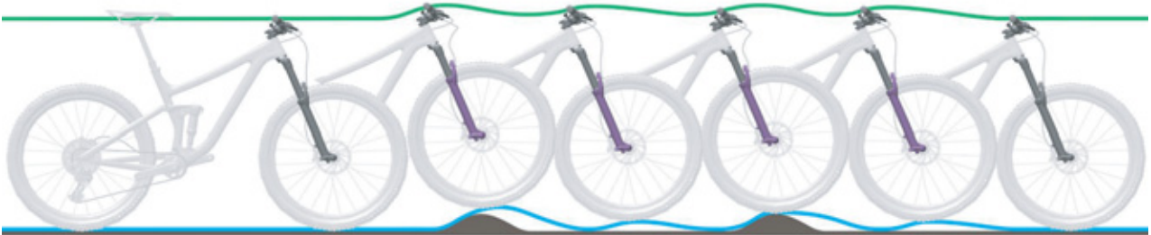
Obr. 70: Příliš rychlé roztahování odpružené vidlice
