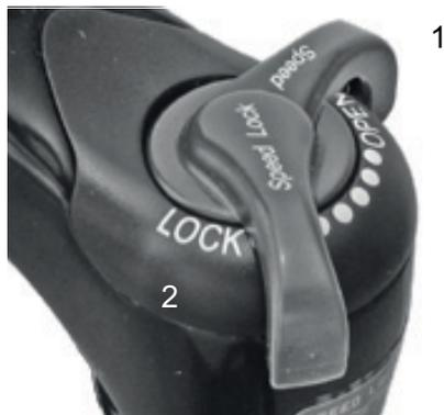
Abbildung 32: Suntour-Druckstufen-Einsteller mit den Positionen OPEN (1) und LOCK (2)
