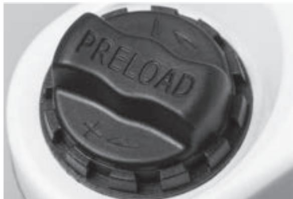
Abbildung 26: Einstellrad des Negativfederwegs auf der Krone der Federgabel
