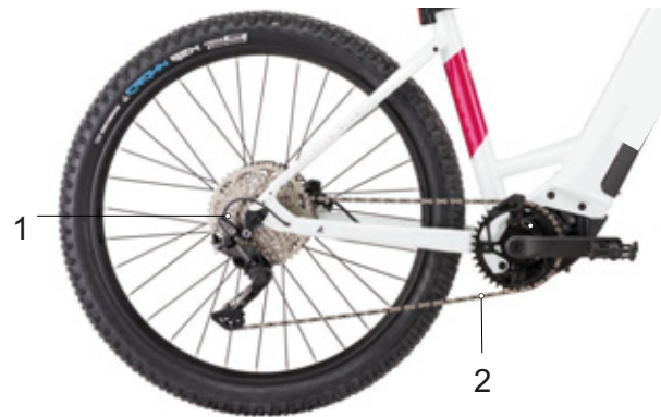
Afbeelding 31: Schema kettingaandrijving met derailleur
