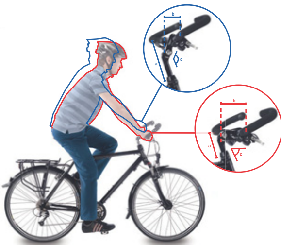
Afbeelding 114: Stadsfiets- (blauw) en toerfietsstand (rood) door verandering van de hoek
