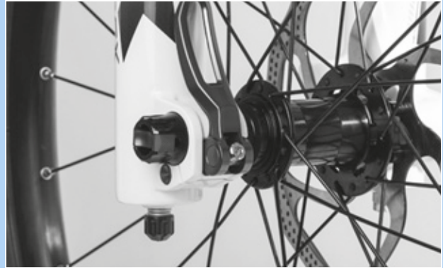
Afbeelding 193: Spankracht van de snelspanner afstellen
