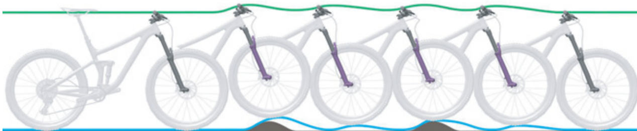
Afbeelding 197: Te snel uitveren van de verende voorvork
