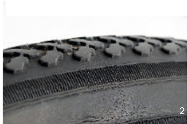
Afbeelding 163: Voorbeelden van vermoeiingsscheuren (1) en verouderingsscheuren (2)
