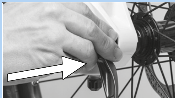
Afbeelding 76: Snelspanner in de richting van de pijl inschuiven
