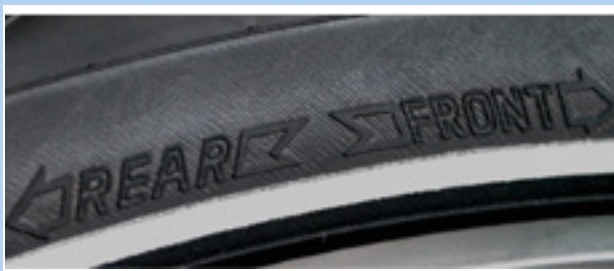
Afbeelding 64: Pijl draairichting op MTB-band
