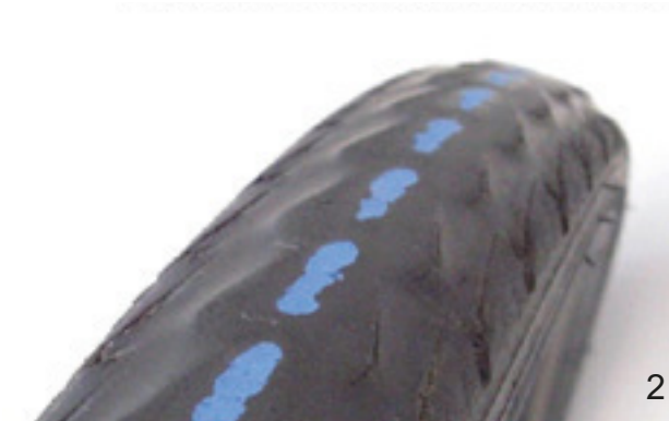
Afbeelding 162: Een band zonder profiel, die kan worden vervangen (1), en een band met zichtbare lekbescherming (2), die moet worden vervangen
