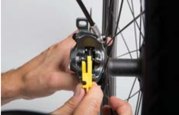
Afbeelding 164: Remvoering in gemonteerde toestand controleren met behulp van de transportbeveiliging
