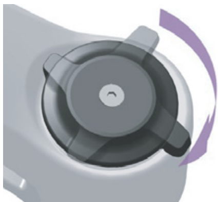
Afbeelding 210: Drukdemperafsteller harder afstellen
