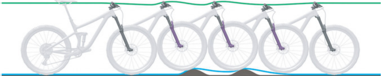
Afbeelding 199: Te langzaam uitveren van de verende voorvork
