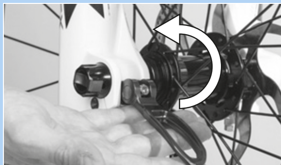
Afbeelding 72: Snelspanhendel in de richting van de pijl drukken
