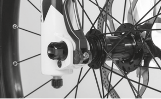
Rysunek 67: Ustawianie siły mocowania zacisku szybkomocującego
