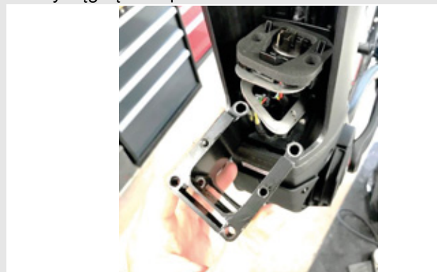
Rysunek 25: Wyciąganie adaptera PowerTube
