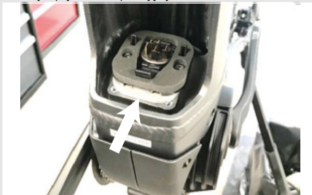
Rysunek 26: Zamontowane płytki adaptacyjne
