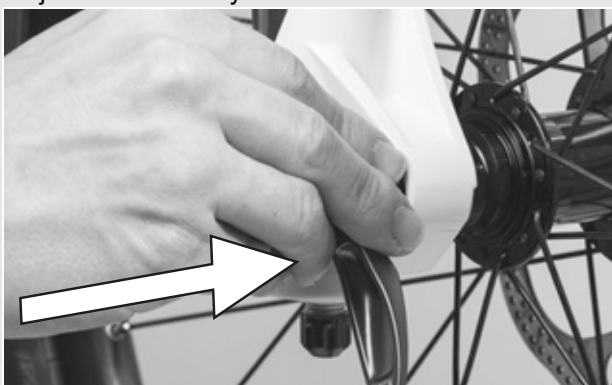
Rysunek 41: Wsuwanie zacisku szybko mocującego
