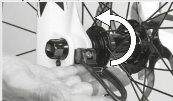
Rysunek 37: Sposób zabezpieczania dźwigni
