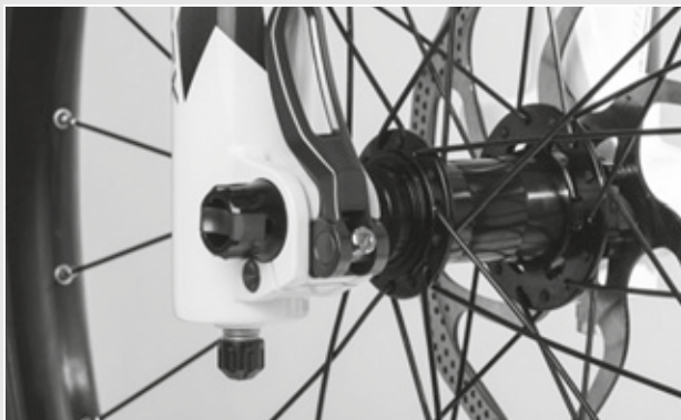
Rysunek 38: Optymalne położenie dźwigni mocującej
