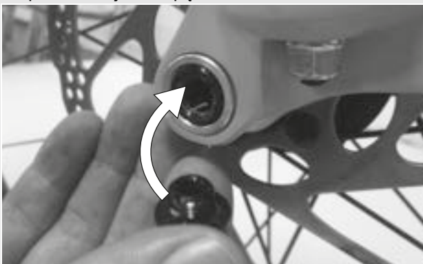
Rysunek 30: Sposób wsuwania dźwigni zacisku szybko mocującego w oś
