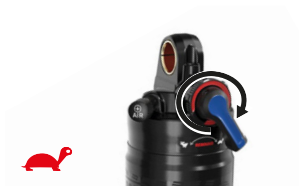
Rysunek 66: Zmniejszanie szybkości rozprężania
