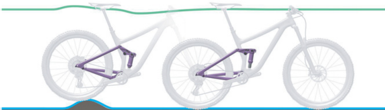
Rysunek 69: Optymalne działanie tylnego amortyzatora na nierównościach
