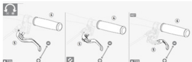
Rysunek 51: Ustawianie odchylenia manetki dźwigni hamulca tarczowego Magura
