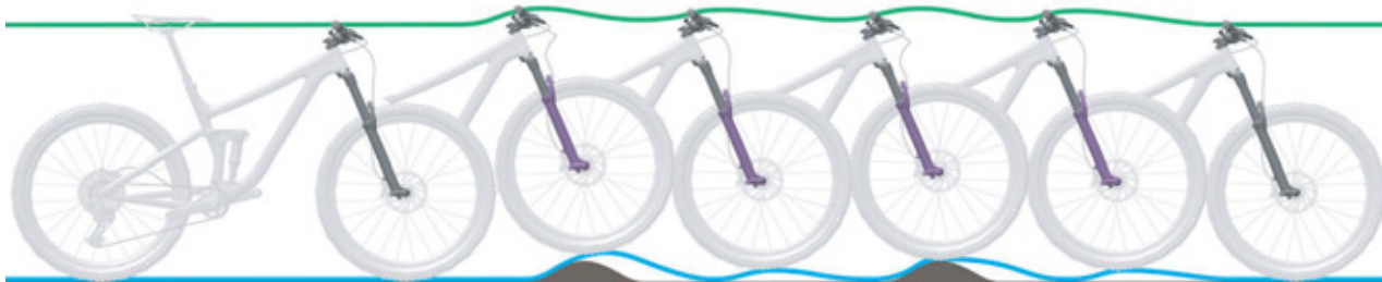
Rysunek 89: Zbyt szybkie rozprężanie widelca amortyzowanego
