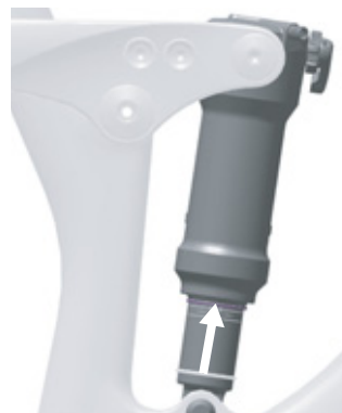
Rysunek 60: Przesuwanie pierścienia o-ring na tylnym amortyzatorze
