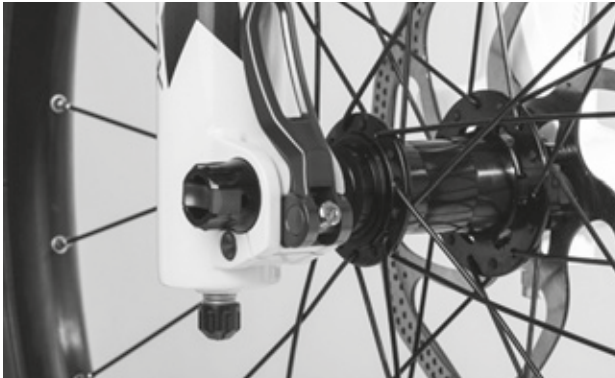
Rysunek 84: Ustawianie siły mocowania zacisku szybkomocującego
