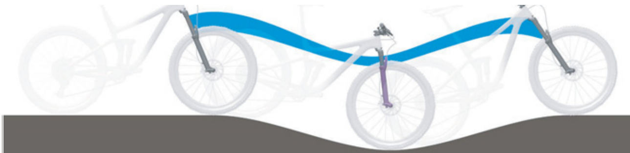
Rysunek 93: Zbyt miękko amortyzowanie widelca na wzniesieniu
