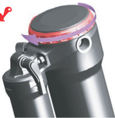
Rysunek 98: Obrócić pokrętkę amortyzatora odbicia w kierunku symbolu żółwia
