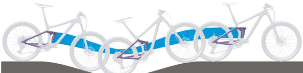
Rysunek 101: Zbyt miękko amortyzowanie tylnego amortyzatora na wzniesieniu
