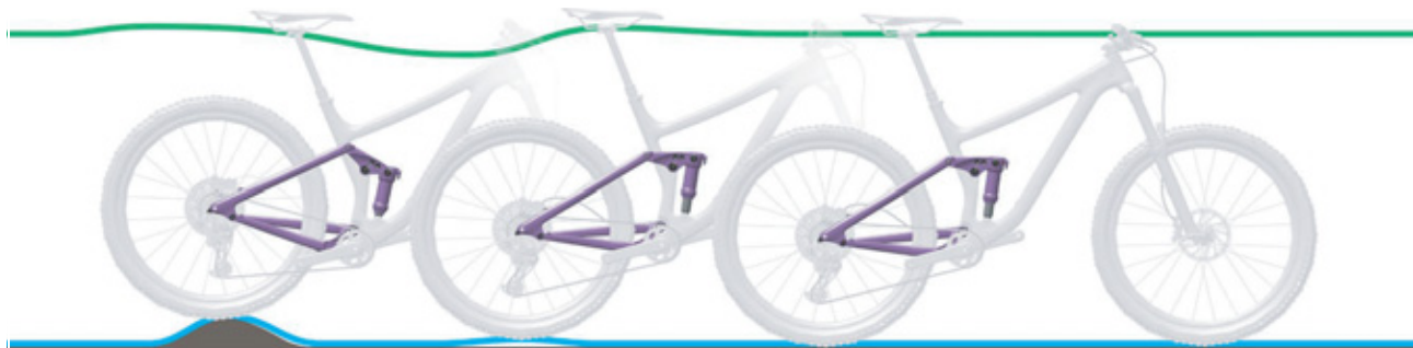
Rysunek 97: Zbyt szybkie rozprężanie się tylnego amortyzatora
