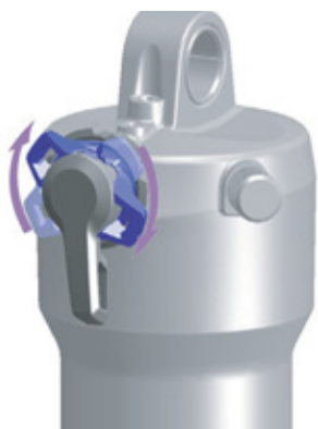
Rysunek 102: Ustawienie nastawnika dobitcia na twardszy tryb pracy
