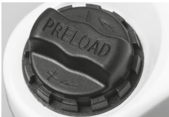
Rysunek 53: Pokrętko regulacyjne parametru SAG usytuowane na koronie widelca amortyzowanego
