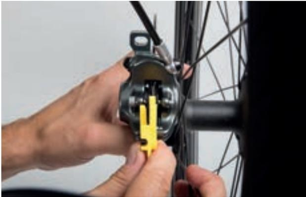
Abbildung 186: Bremsbelag im eingebauten Zustand mithilfe der Transportsicherung prüfen
