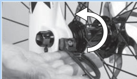
Abbildung 87: Schnellspannhebel in Pfeilrichtung drücken
