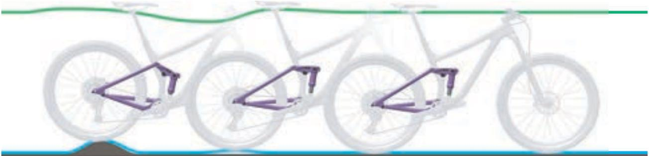
Abbildung 224: Zu schnelles Ausfedern des Hinterbau-Dämpfers
