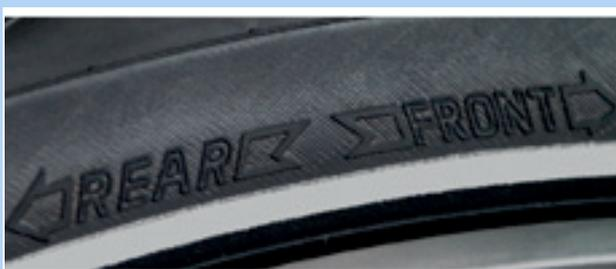
Abbildung 95: Laufrichtungspfeil auf MTB-Reifen
