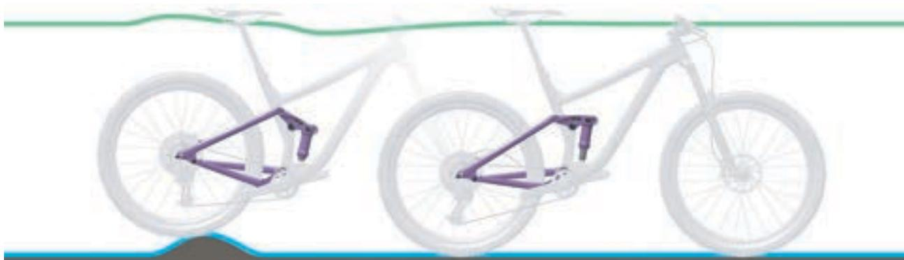
Abbildung 164: Optimales Fahrverhalten des Hinterbau-Dämpfers bei Unebenheiten
