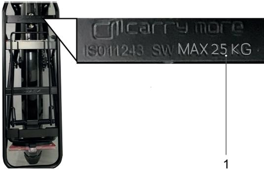
Abbildung 157: Auf dem Gepäckträger ist seine maximale Tragfähigkeit (1) ausgewiesen.
