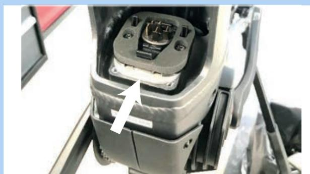
Abbildung 70: Eingebaute Adapterplatten
