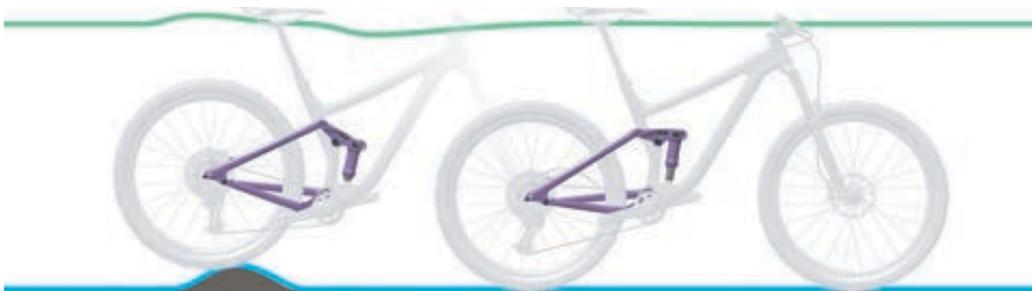
Abbildung 137: Optimales Fahrverhalten des Hinterbau-Dämpfers bei Unebenheiten
