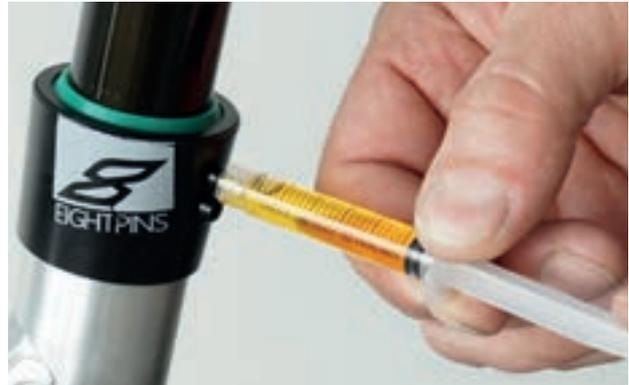
Abbildung 182: Eightpins Sattelstütze schmieren
