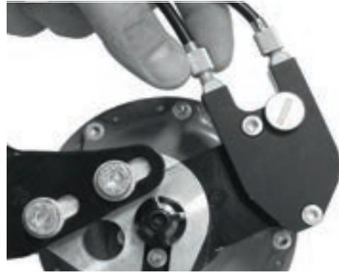
Abbildung 211: ROHLOFF-Naben Versionen mit externer Schaltansteuerung haben die Zugeinsteller an der Seilbox, die sich auf der linken Seite befindet
