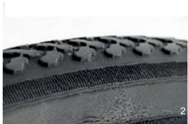
Abbildung 185: Beispiele für Ermüdungsrisse (1) und Alterungsrisse (2)
