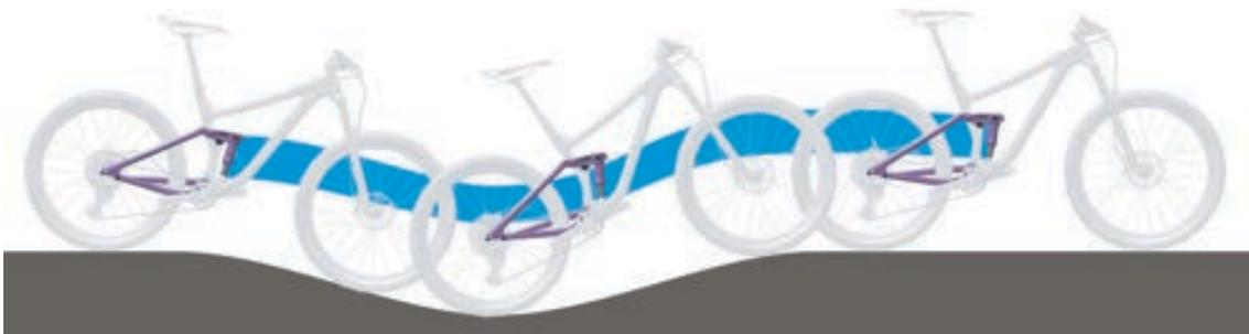
Abbildung 136: Optimales Fahrverhalten des Hinterbau-Dämpfers im hügeligen Gelände
