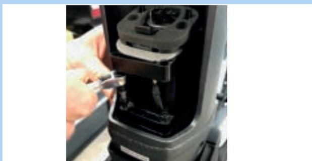
Abbildung 67: 4 mm 6-Kant-Schrauben entfernen
