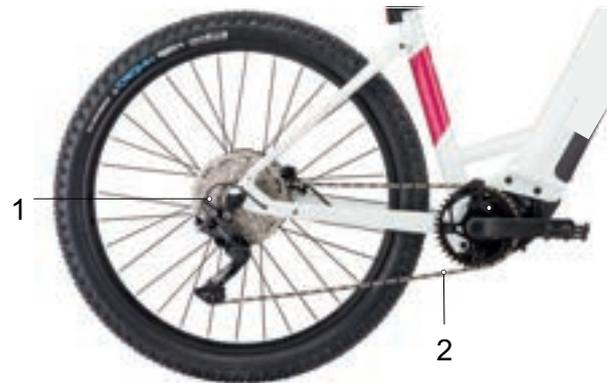
Abbildung 45: Schema Kettenantrieb mit Kettenschaltung
