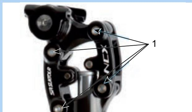
Abbildung 216: Schmierpunkte SR SUNTOUR Feder-Sattelstütze
