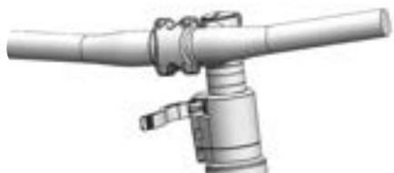
Abbildung 154: Beispiel All Up mit geöffnetem Vorbau-Spannhebel
