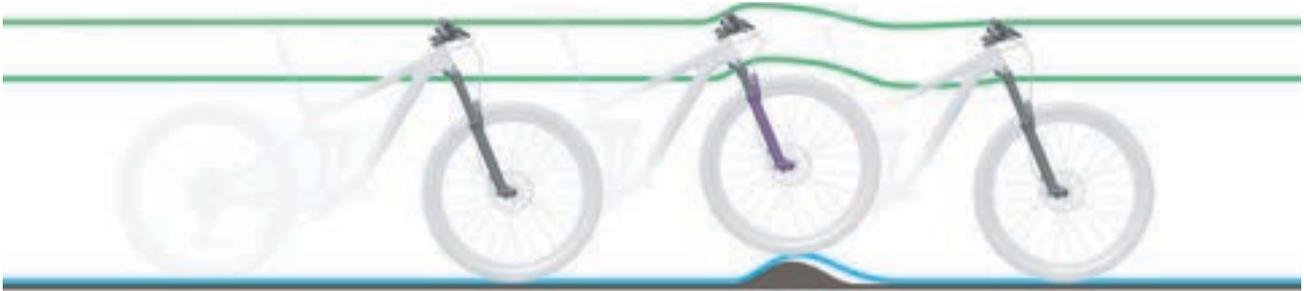
Abbildung 223: Zu harte Dämpfung der Federgabel bei Unebenheiten
