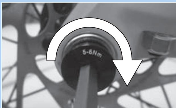
Abbildung 83: Sicherungsschraube anziehen
