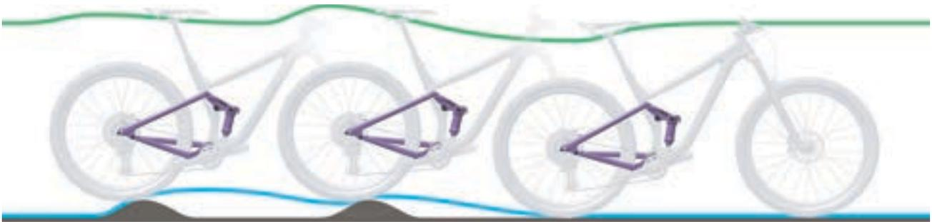
Abbildung 226: Zu langsames Ausfedern des Hinterbau-Dämpfers
