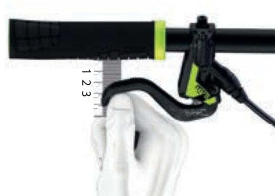
Abbildung 128: Positionierung Handbremse
