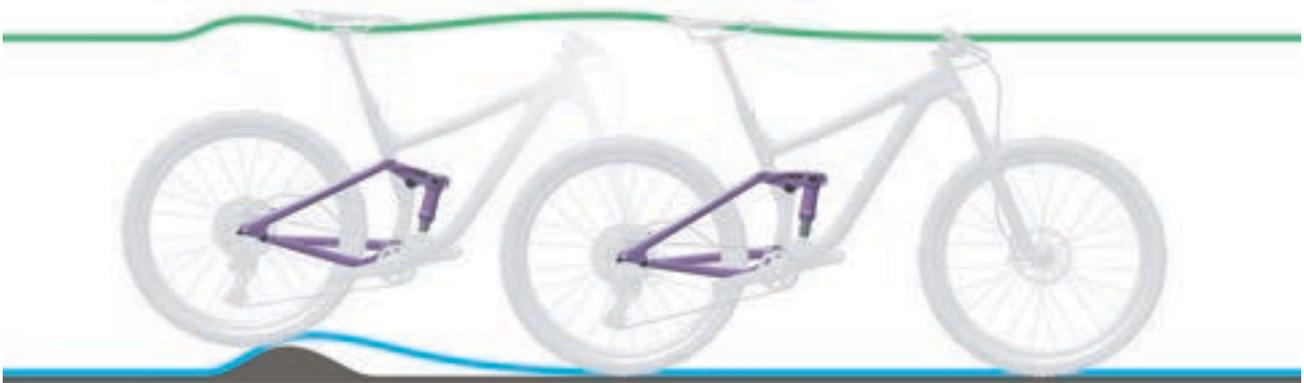
Abbildung 230: Zu harte Dämpfung des Hinterbau-Dämpfers bei Unebenheiten
