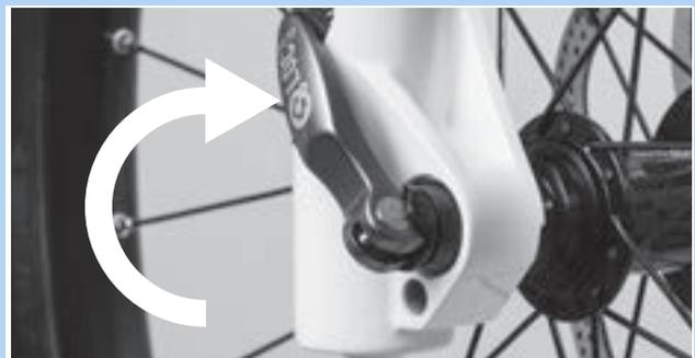
Abbildung 93: Schnellspanner schließen
