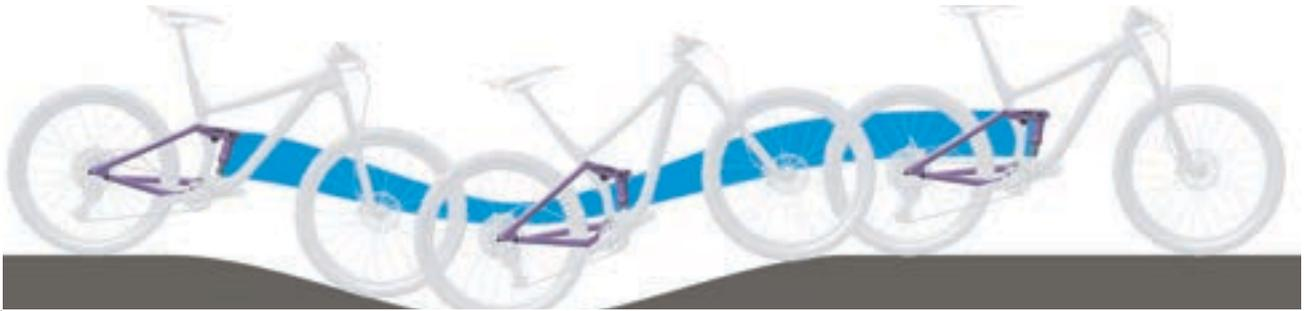
Abbildung 228: Zu weiche Federung des Hinterbau-Dämpfers am Berg
