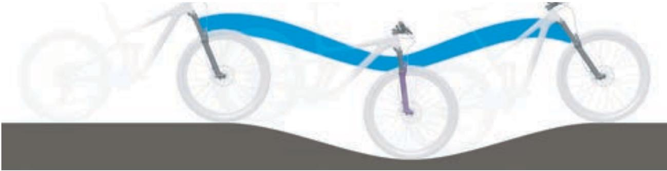
Abbildung 131: Optimales Fahrverhalten der Gabel im hügeligen Gelände
