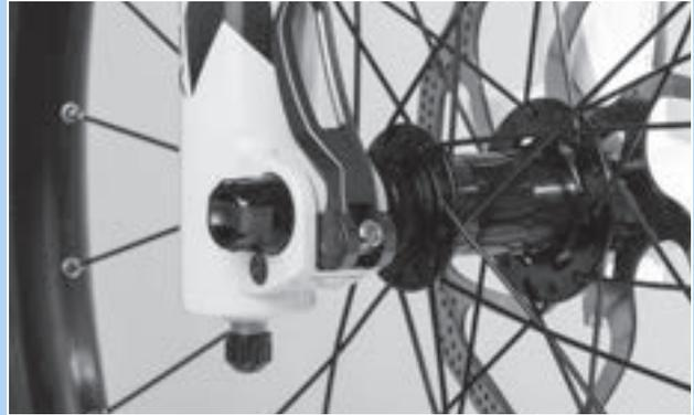
Abbildung 214: Spannkraft des Schnellspanners einstellen
