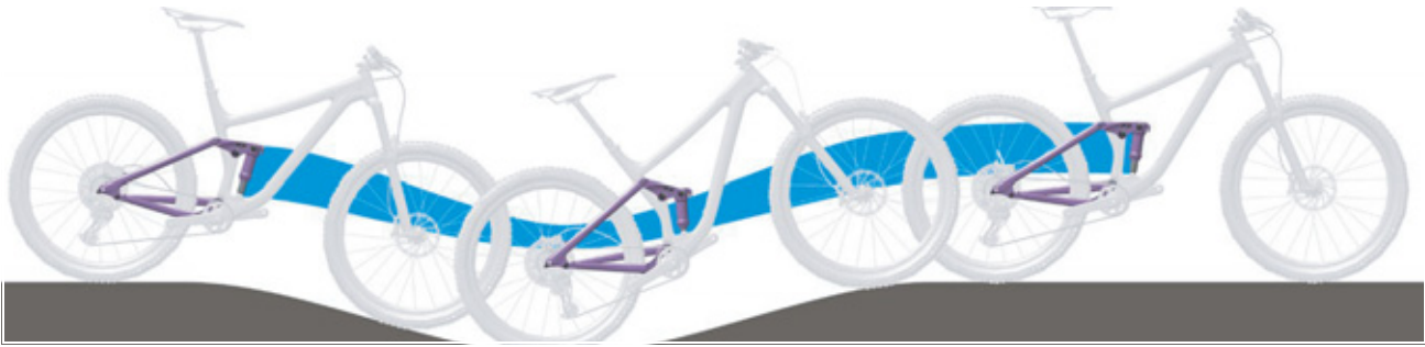
Figura 246: Sospensione dell'ammortizzatore del carro posteriore troppo morbida in salita
