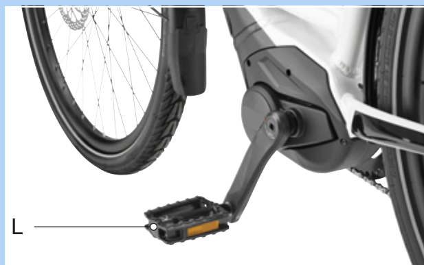
Figura 59: Pedale L nel braccio sinistro della pedivella
