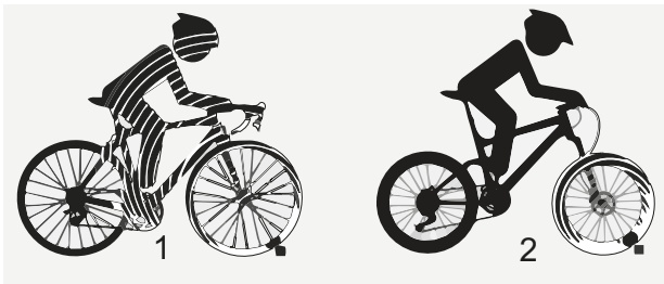
Figura 7: Senza sospensione (1) e con sospensione (2)
