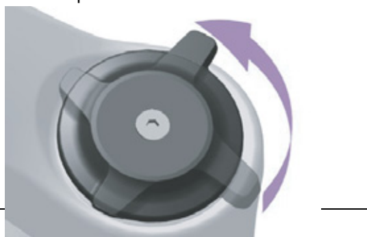
Figura 150: Regolazione più morbida del regolatore dello stadio di compressione
