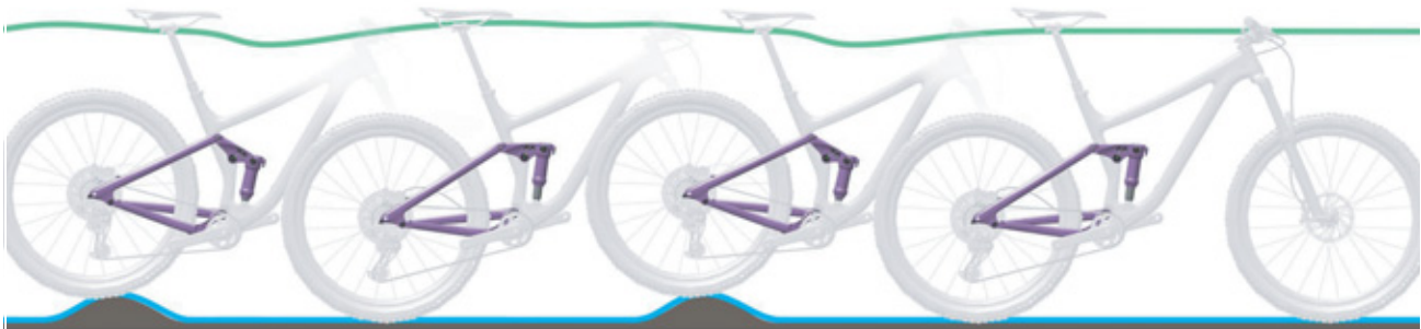
Figura 16: Comportamento di marcia ottimale dell'ammortizzatore del carro posteriore
