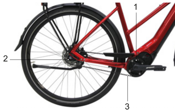
Figura 37: Schema della trasmissione a cinghia
