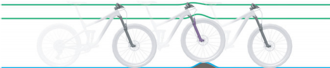
Figura 11: Comportamento di marcia ottimale della forcella su un terreno con asperità
