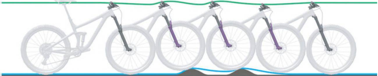
Figura 236: Corsa di estensione troppo lenta della forcella ammortizzata
