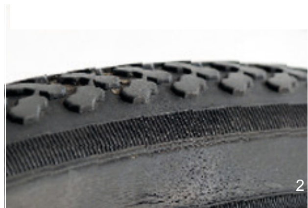
Figura 160: Esempi di crepe da fatica (1) e da invecchiamento (2)
