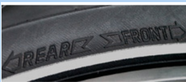
Figura 57: Freccia del senso di rotazione su pneumatici MTB
