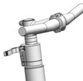
Figura 152: All Up con leva di serraggio dell'attacco manubrio aperta
