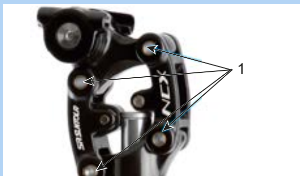
Figura 171: Punti di lubrificazione del cannotto reggisella ammortizzato SR Suntour
