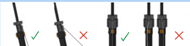
Figura 199: Cavo meccanico corretto ed errato
