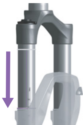
Figura 88: Spostamento dell'O-ring sulla forcella ammortizzata
