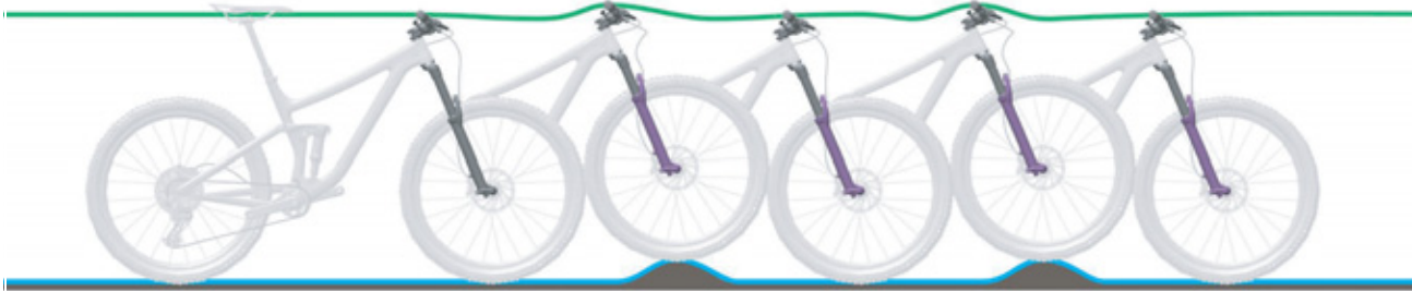
Figura 9: Comportamento di marcia ottimale della forcella
