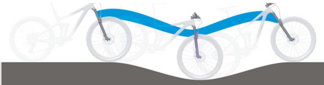
Figura 10: Comportamento di marcia ottimale della forcella su un terreno con dossi
