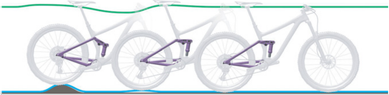
Figura 242: Corsa di estensione troppo veloce dell'ammortizzatore del carro posteriore
