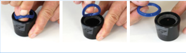
Figura 217: Estrazione del parapolvere
