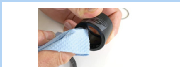
Figura 184: Pulizia della boccola esterna
