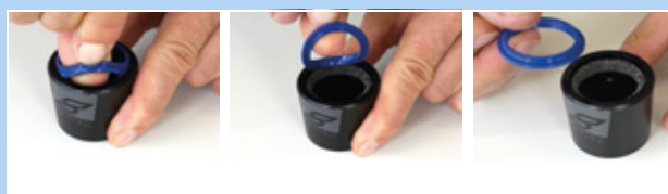
Figura 182: Estrazione del parapolvere
