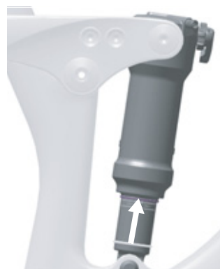
Figura 106: Spostamento dell'O-ring sull'ammortizzatore del carro posteriore
