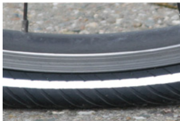
Figura 82: Pressione di gonfiaggio insufficiente
