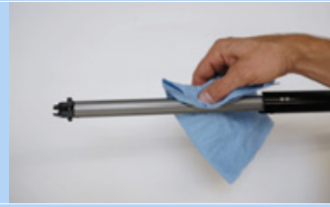
Figura 225: Pulizia della scanalatura di guida longitudinale
