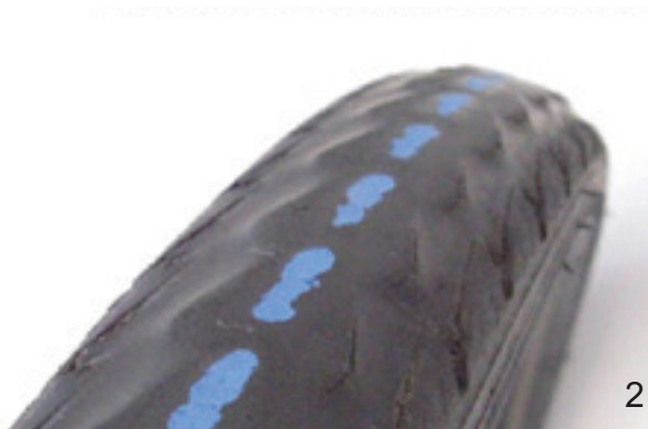
Figura 159: Pneumatico senza profilo ancora utilizzabile (1) e pneumatico con protezione contro le forature in vista (2) che deve essere sostituito
