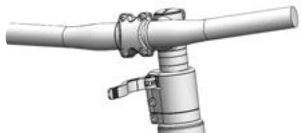
Figura 130: Esempio: All Up con leva di serraggio dell'attacco manubrio aperta
