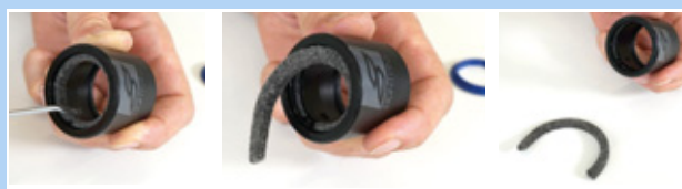
Figura 183: Rimozione dell'anello di feltro
