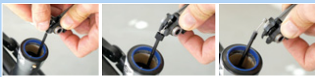
Figura 213: Rimozione del cavo meccanico
