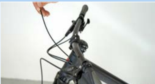
Figura 231: Aggancio del cappuccio terminale
