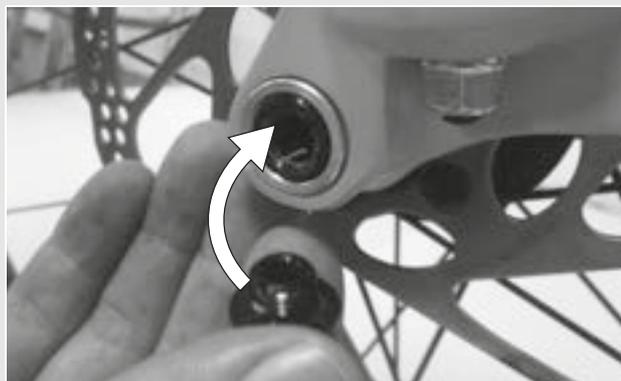
Illustration 22 : Enfoncer le levier d'attache rapide dans l'axe
