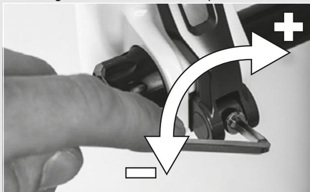
Illustration 31 : Régler la force de serrage de l'attache rapide
