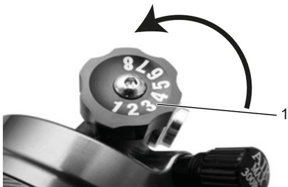
Illustration 56 : Molette de réglage de la compression Suntour (1) sur l'amortisseur arrière
