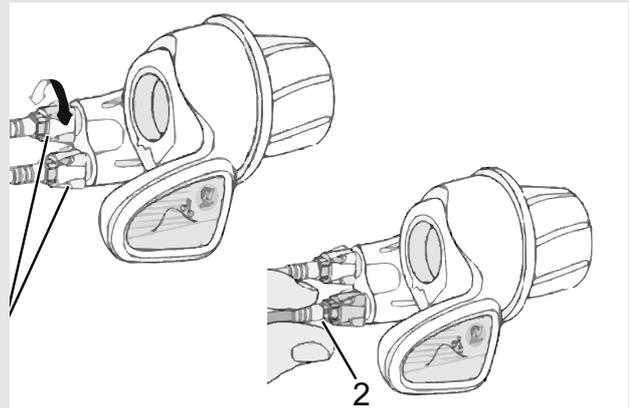
Illustration 76 : Poignée de vitesse rotative avec douilles de réglage (1) et jeu du changement de vitesse (2)
