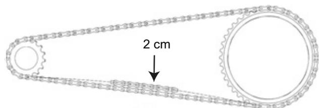
Illustration 71 : Contrôler la tension de la chaîne
