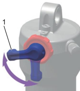
Illustration 68 : Régler la dureté de l'amortisseur de compression sur le levier (1) de l'amortisseur arrière
