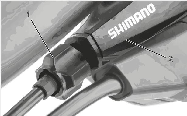
Illustration 74 : Douille de réglage (1) du changement de vitesse à un câble actionné par câble avec boîtier de manette de vitesse (2), exemple
