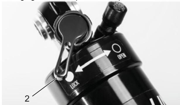
Illustration 66 : Dispositif de réglage de la compression Suntour fermé (2)
