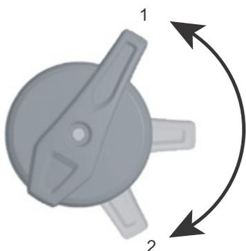
Illustration 61 : Dispositif de réglage de la compression FOX avec les positions OUVERT (1) et DUR (2)
