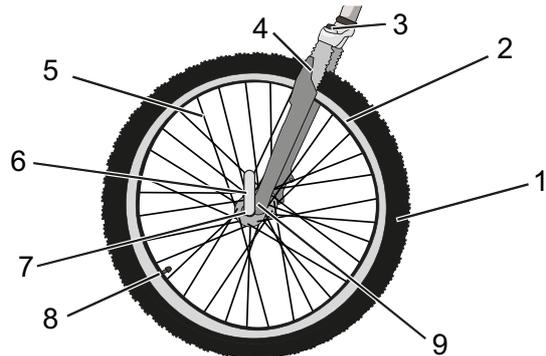
Illustration 3 : Composants de la roue, exemple de la roue avant
