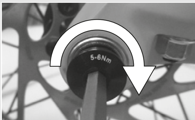
Illustration 26 : Serrer la vis de blocage
