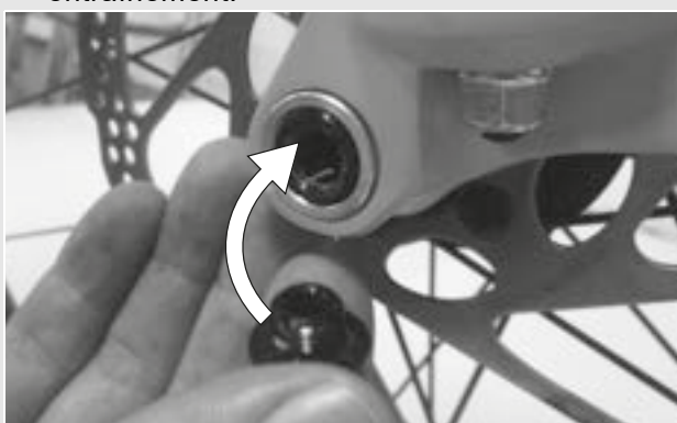
Illustration 25 : Enfoncer le levier d'attache rapide dans l'axe
