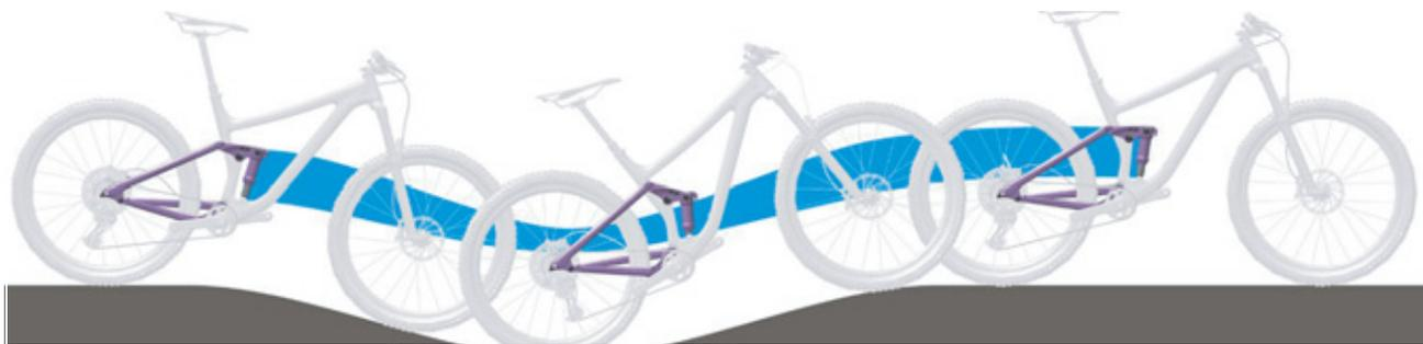
Illustration 225 : Suspension trop souple de l'amortisseur arrière dans les côtes
