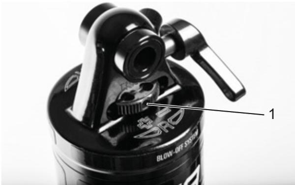
Illustration 214 : Molette de réglage de la détente SR SUNTOUR (1) sur l'amortisseur arrière
