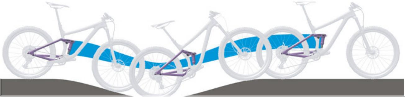
Illustration 217 : Suspension trop souple de l'amortisseur arrière dans les côtes
