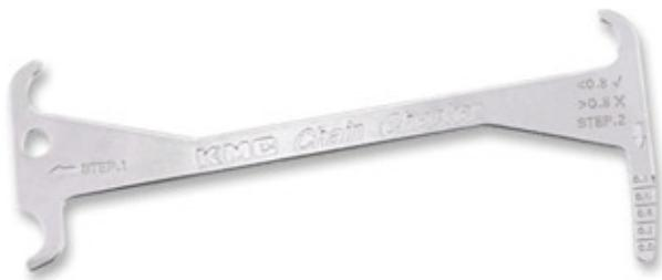
Illustration 167 : Exemple d'un gabarit de mesure KMC
