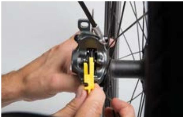
Illustration 164 : Contrôler la plaquette de frein montée à l'aide de la cale de transport
