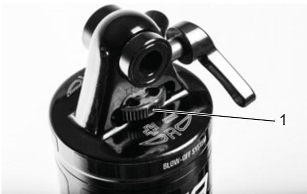
Illustration 216 : Molette de réglage de la détente SR SUNTOUR (1) sur l'amortisseur arrière
