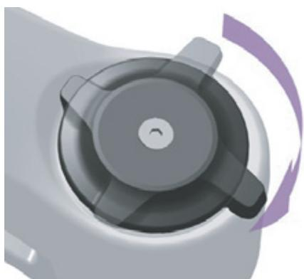
Illustration 210 : Régler le dispositif de réglage de la compression sur un niveau plus dur
