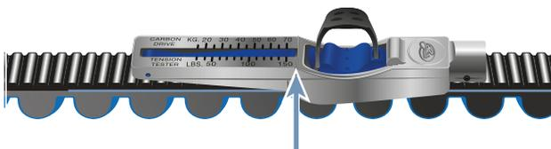
**Illustration 181 : Gabarit de contrôle sur la courroie**
