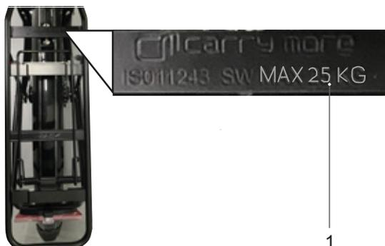
Illustration 139 : La capacité de charge maximale (1) est indiquée sur le porte-bagages.
