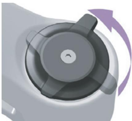
Illustration 212 : Régler le dispositif de réglage de la compression sur un niveau plus souple
