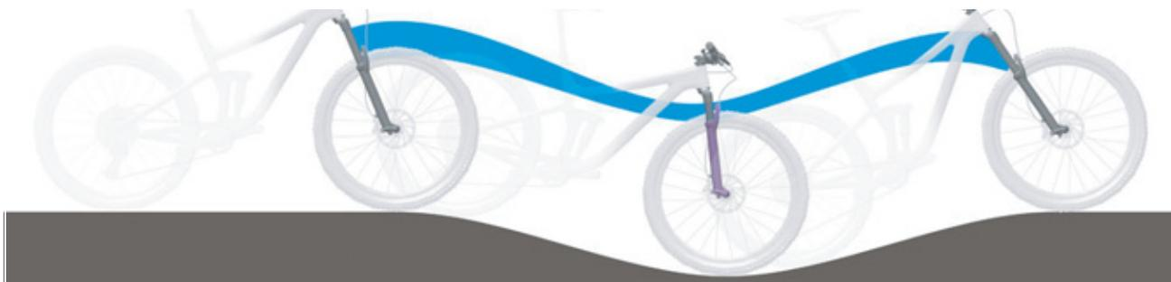
Illustration 201 : Suspension trop souple de la fourche suspendue dans les côtes
