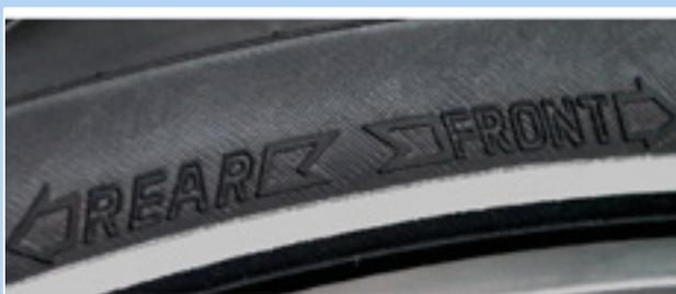
Illustration 64 : Flèche directionnelle sur les pneus VTT
