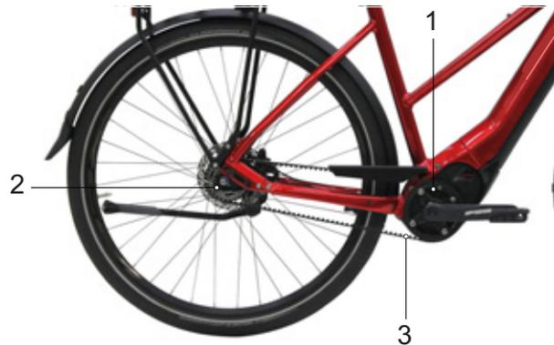
Illustration 32 : Schéma de l'entraînement à courroie
