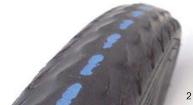
Illustration 162 : Pneu sans profil pouvant être changé (1) et pneu avec protection anti-crevaison visible (2) devant être changé
