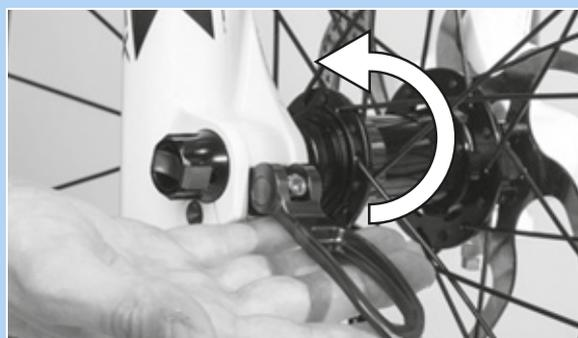
Illustration 72 : Enfoncez le levier d'attache rapide dans le sens de la flèche
