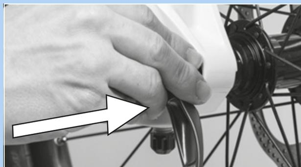
Illustration 76 : Enfoncez l'attache rapide dans le sens de la flèche
