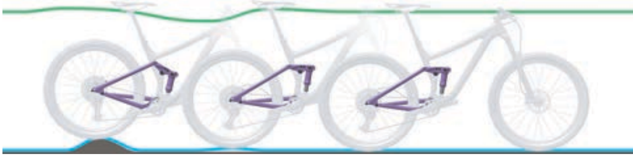
Abbildung 74: Zu schnelles Ausfedern des Hinterbau-Dämpfers
