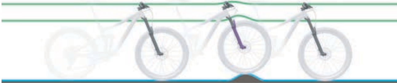
Abbildung 7: Optimales Fahrverhalten der Gabel bei Unebenheiten
