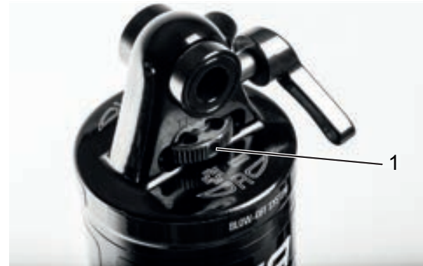
Abbildung 81: Suntour-Zugstufeneinsteller Rad (1) am Hinterbau-Dämpfer
