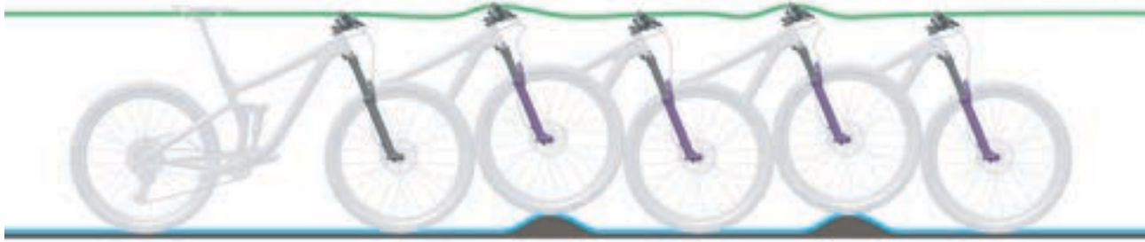
Abbildung 5: Optimales Fahrverhalten der Gabel
