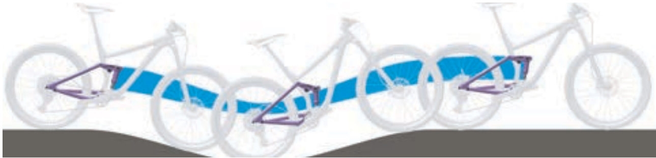
Abbildung 78: Zu weiche Federung des Hintebau-Dämpfers am Berg
