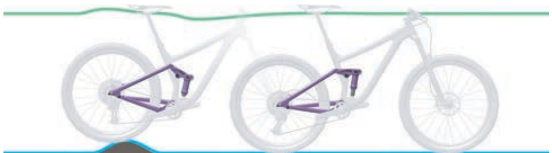
Abbildung 12: Optimales Fahrverhalten des Hinterbau-Dämpfers bei Unebenheiten
