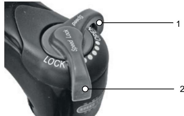
Abbildung 62: Suntour-Druckstufendämpfer in offener (1) und geschlossener (2) Position
