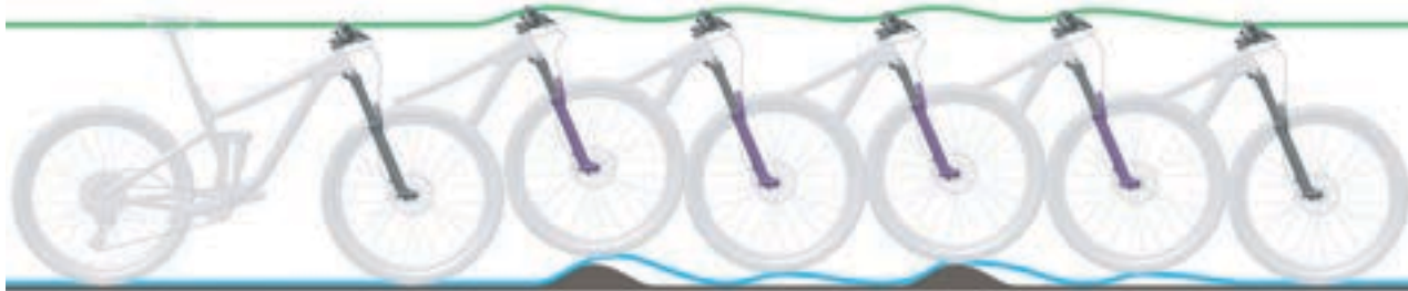
Abbildung 144: Zu schnelles Ausfedern der Federgabel
