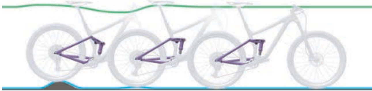
Abbildung 152: Zu schnelles Ausfedern des Hinterbau-Dämpfers
