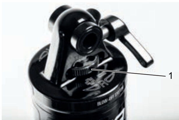
Abbildung 77: Zugstufendämpfer gegen den Uhrzeigersinn drehen
