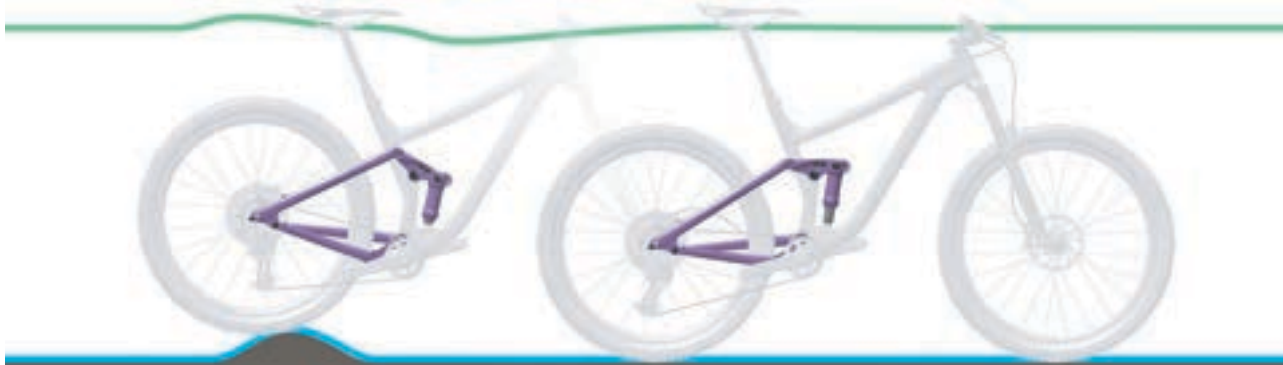
Abbildung 85: Optimales Fahrverhalten des Hinterbau-Dämpfers bei Unebenheiten
