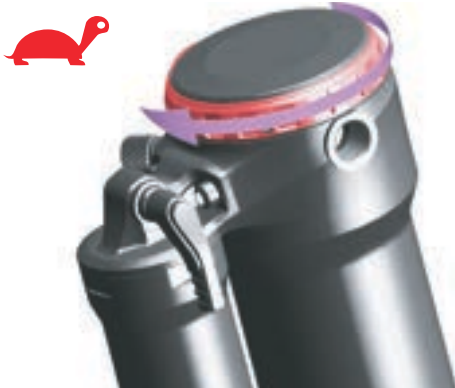
Abbildung 153: Zugstufendämpfer in Richtung Schildkröte drehen
