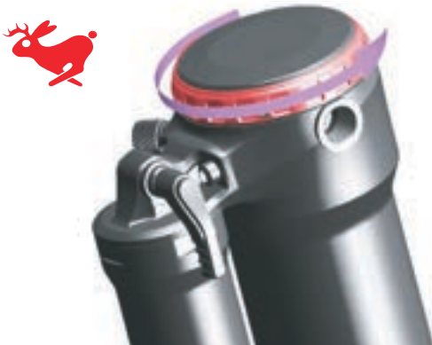
Abbildung 155: Zugstufendämpfer in Richtung Hase drehen
