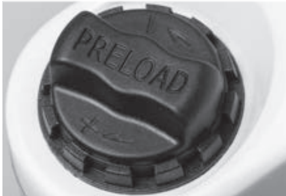
Abbildung 75: Einstellrad SAG auf der Krone der Federgabel
