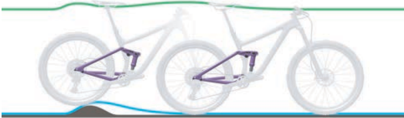
Abbildung 80: Zu harte Dämpfung des Hinterbau-Dämpfers bei Unebenheiten
