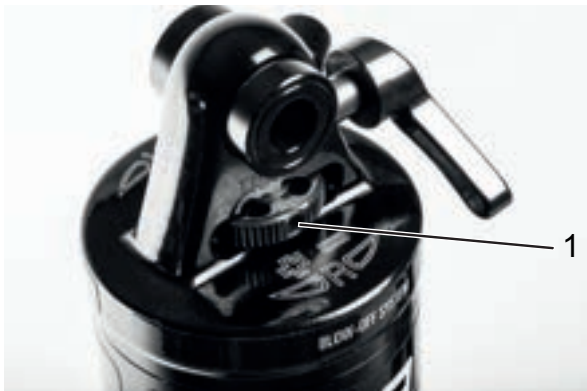
Abbildung 75: Zugstufendämpfer im Uhrzeigersinn drehen
