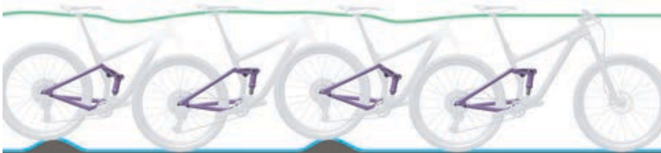
Abbildung 79: Optimales Fahrverhalten des Hinterbau-Dämpfers
