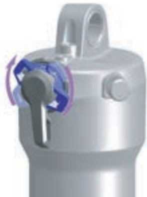
Abbildung 157: Druckstufeneinsteller härter einstellen
