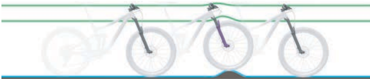
Abbildung 61: Optimales Fahrverhalten bei Unebenheiten
