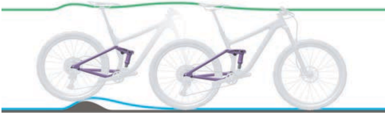
Abbildung 158: Zu harte Dämpfung des Hinterbau-Dämpfers bei Unebenheiten
