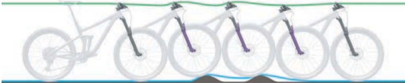
Abbildung 68: Zu langsames Ausfedern der Federgabel
