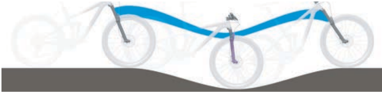
Abbildung 148: Zu weiche Federung der Federgabel am Berg
