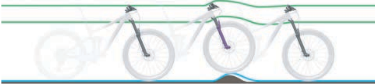
Abbildung 72: Zu harte Dämpfung der Federgabel bei Unebenheiten
