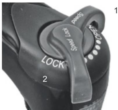
Illustration 32 : Dispositif de réglage de la compression Suntour avec les positions OPEN (1) et LOCK (2)
