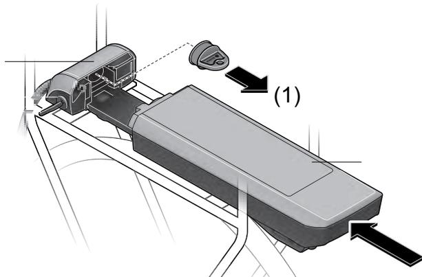
Abbildung 83: Offene Kontakte mit Abdeckklappe abdecken, Beispiel Gepäckträger
