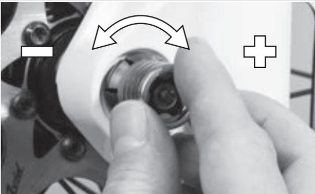
Abbildung 53: Spannung einstellen
