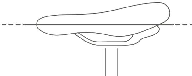
Abbildung 59: Waagerechte Sattelneigung
