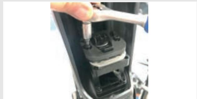
Abbildung 26: Akkuhalter Schrauben lösen
