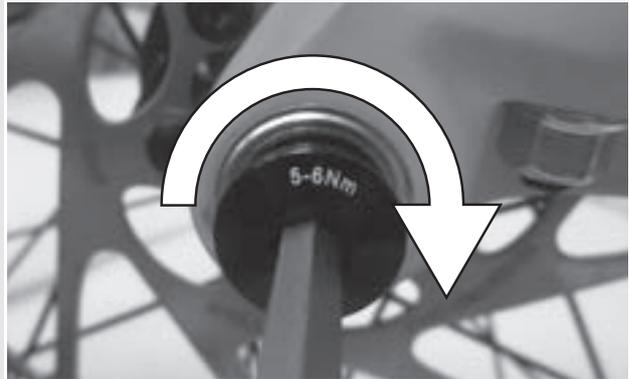
Abbildung 42: Sicherungsschraube anziehen
