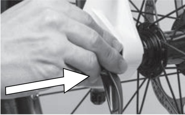
Abbildung 52: Schnellspanner hineinschieben
