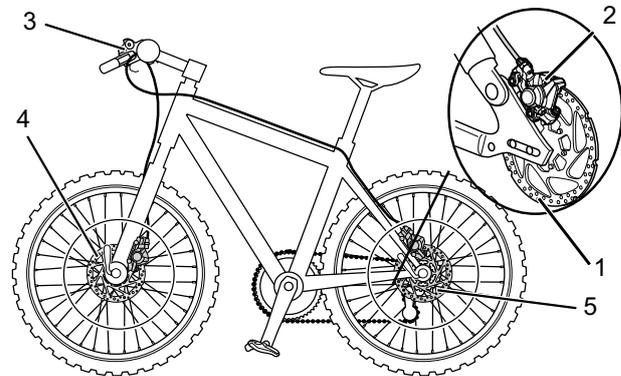
Abbildung 11: Bremssystem mit Scheibenbremse, Beispiel
