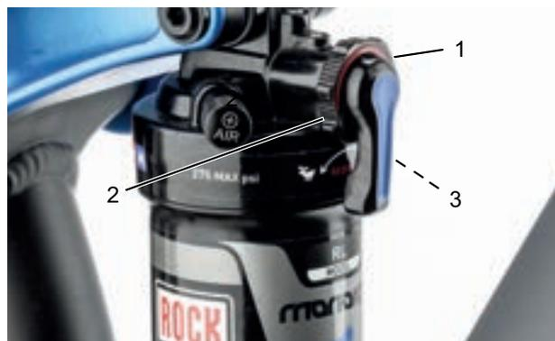
Abbildung 88: Härte des Zugstufen-Dämpfers am Einstellrad (1) des Hinterbau-Dämpfer einstellen
