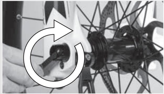
Abbildung 46: Achse anziehen
