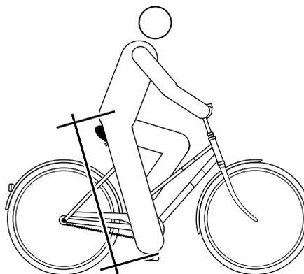
Abbildung 60: Optimale Sattelhöhe
