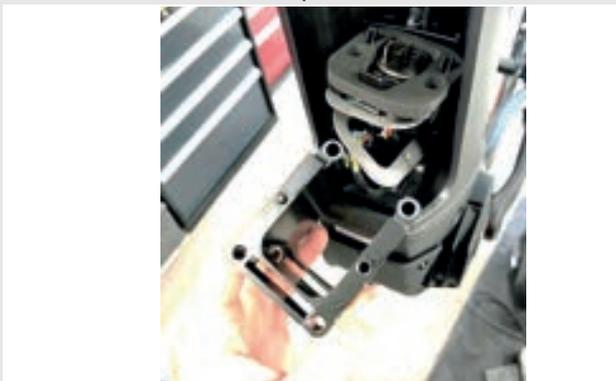
Abbildung 29: PowerTube Adapter herausziehen
