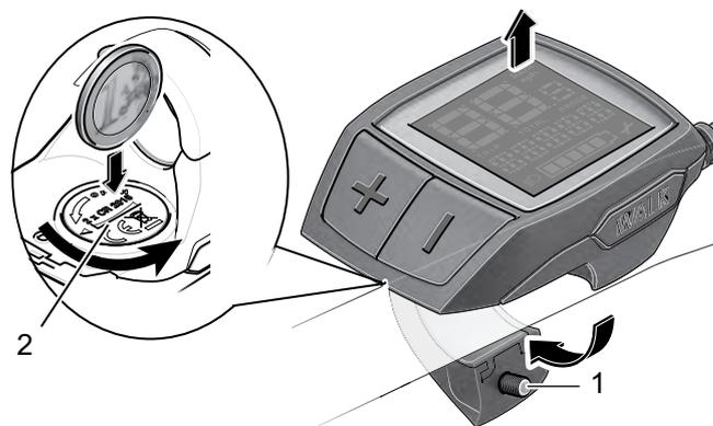
Abbildung 85: Bildschirm mit Befestigungsschraube (1) und Batteriefachdeckel (2)
