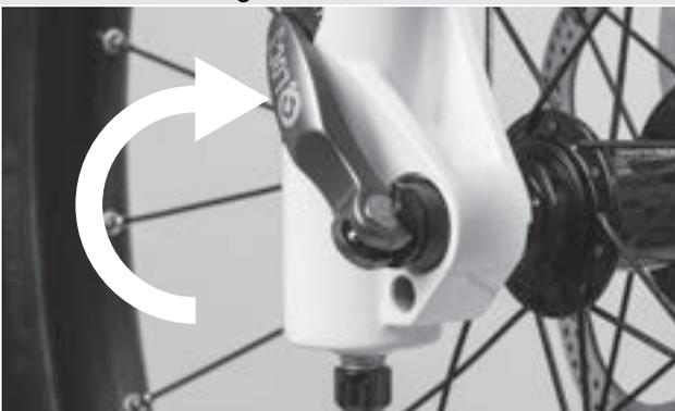
Abbildung 54: Schnellspanner schließen
