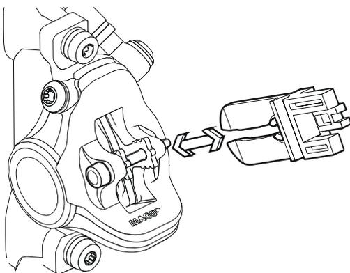
Abbildung 25: Transportsicherung befestigen
