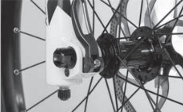
Abbildung 49: Perfekte Lage des Spannhebels
