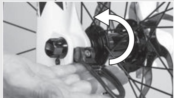
Abbildung 48: Hebel sichern
