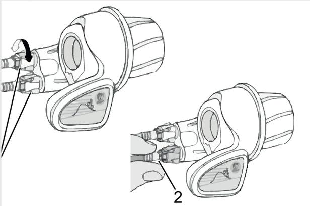
Abbildung 97: Drehgriffschalter mit Einstellhülsen (1) und Spiel der Gangschaltung (2).
