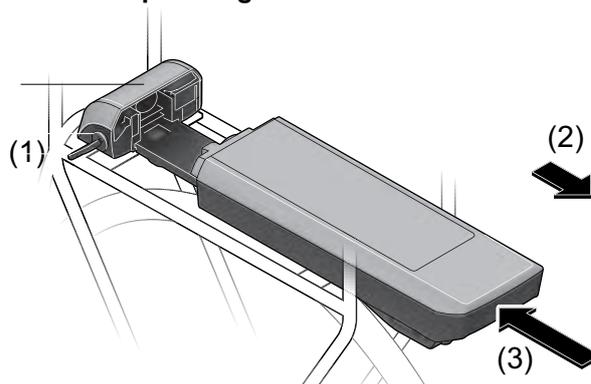
Abbildung 80: Gepäckträgerakku herausnehmen (2) und einsetzen (3)
