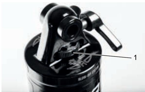
Abbildung 74: Suntour-Zugstufeneinsteller Rad (1) am Hinterbau-Dämpfer
