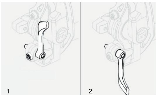
Abbildung 10: Verriegelungshebel der Felgenbremse, geschlossen (1) und geöffnet (2)
