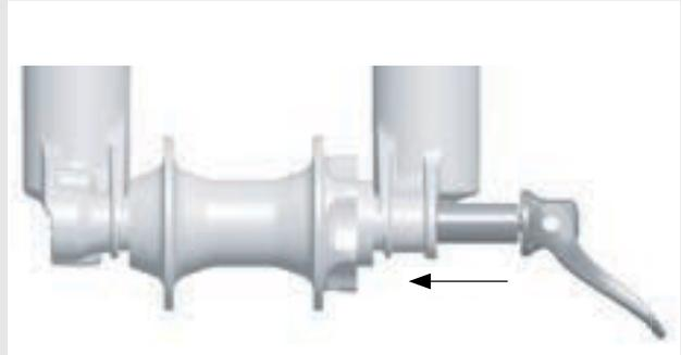
Abbildung 55: Schnellspanner einschieben
