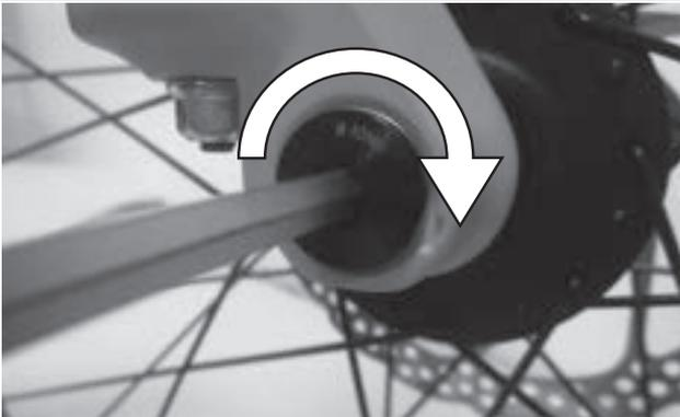
Abbildung 40: Achse anziehen
