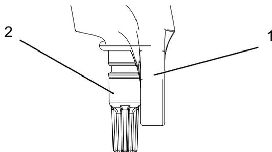
Abbildung 72: Suntour-Zugstufen-Schraube (2), Gabel (1)
