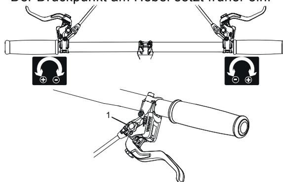
Abbildung 69: Benutzung des Drehknopfs (1) zur Druckpunkt-Einstellung
