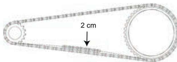
Abbildung 92: Kettenspannung prüfen
