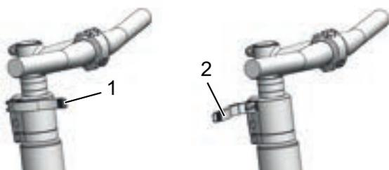
Abbildung 64: Geschlossener (1) und geöffneter (2) Vorbau-Spannhebel, Beispiel All Up
