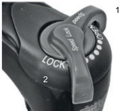
Abbildung 87: Suntour-Druckstufen-Einsteller mit den Positionen OPEN (1) und LOCK (2)
