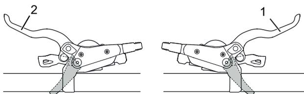
Abbildung 86: Bremshebel Hinten (1) und vorne (2), Beispiel Shimano Bremse
