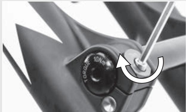
Abbildung 44: Sicherheitsklemme anziehen
