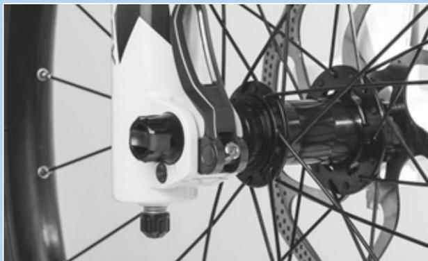
Figura 193: Ajuste de la fuerza de tensado del cierre rápido
