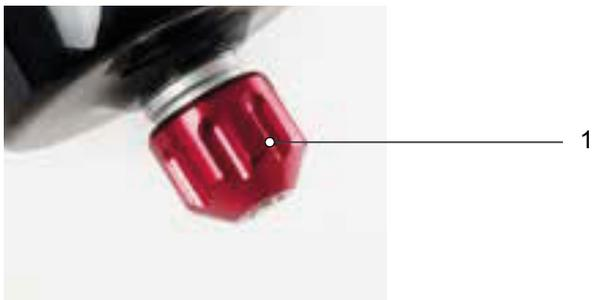
Figura 200: Tornillo de niveles de tracción SR SUNTOUR (1)
