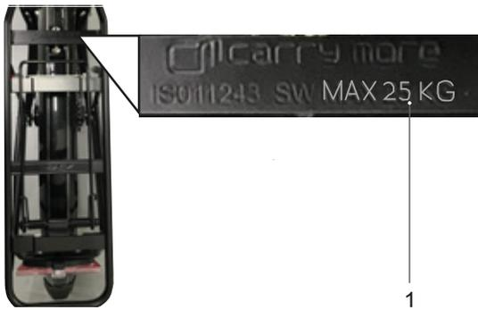
Figura 139: En el portaequipajes se indica la capacidad máxima de carga (1)
