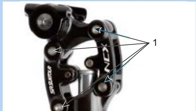
Figura 195: Puntos de lubricación de la tija de sillín de muelle SR SUNTOUR
