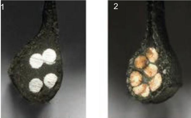
Figura 19: Núcleo de acero (1) y núcleo de Kevlar (2)
