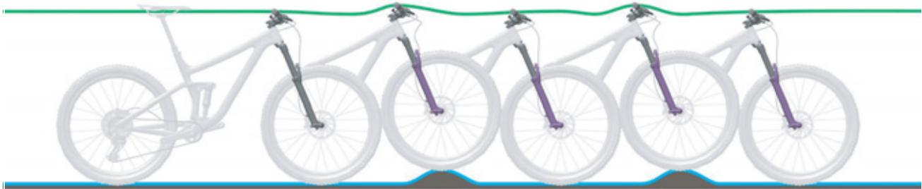
Figura 125: Condición óptima de marcha de la horquilla
