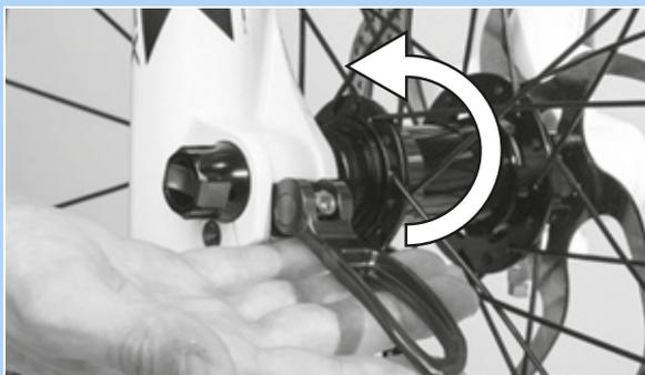
Figura 72: Presión de la palanca de cierre rápido en la dirección de la flecha
