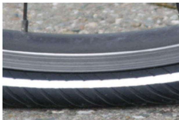
Figura 117: Presión de inflado demasiado baja
