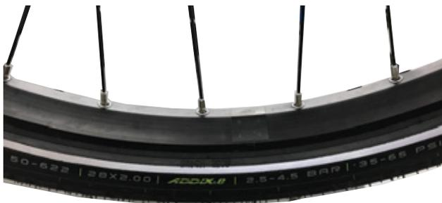
Figura 17: Ejemplo: Información en la cubierta
