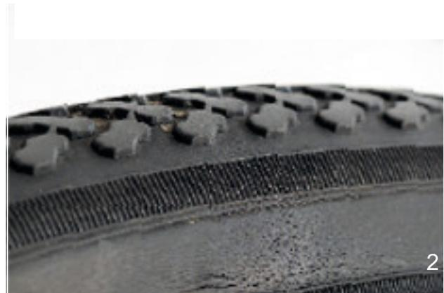
Figura 163: Ejemplos de fisuras por fatiga (1) y fisuras por envejecimiento (2)
