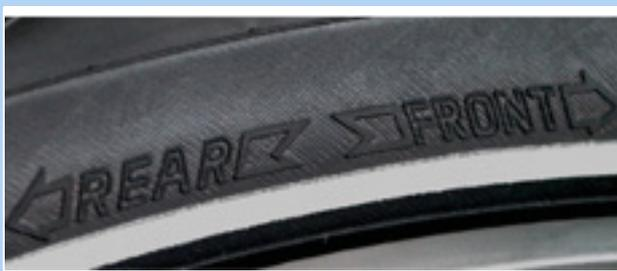
Figura 64: Flecha de sentido de la marcha en cubiertas de MTB
