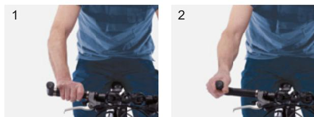
Figura 142: Posiciones de agarre en el acople de manillar
