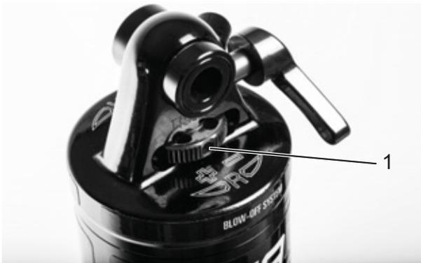
Figura 214: Rueda del regulador de niveles de tracción SR SUNTOUR (1) en el amortiguador de la horquilla trasera
