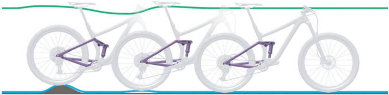
Figura 213: Descompresión demasiado rápida del amortiguador de la horquilla trasera
