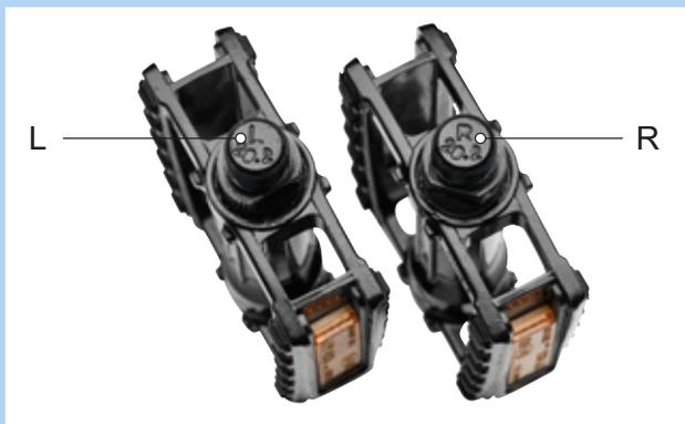
Figura 84: Ejemplo de identificación de los pedales
