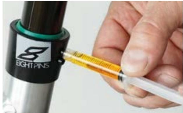
Figura 160: Lubricación de la tija de sillín eightpins
