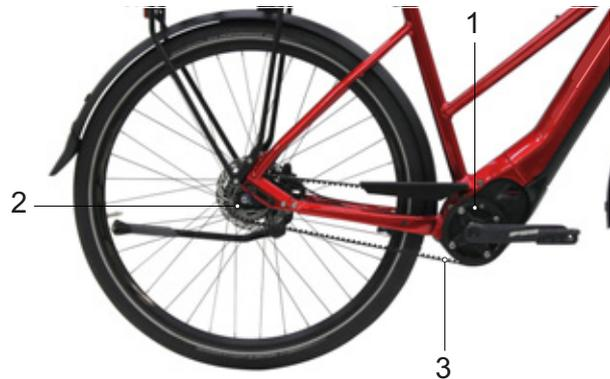
Figura 32: Esquema de la transmisión por correa
