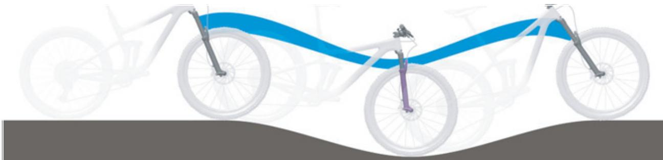
Figura 209: Suspensión de la horquilla de suspensión demasiado blanda en montaña
