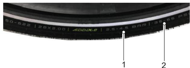
Figura 161: Presión de inflado en bar (1) y psi (2)
