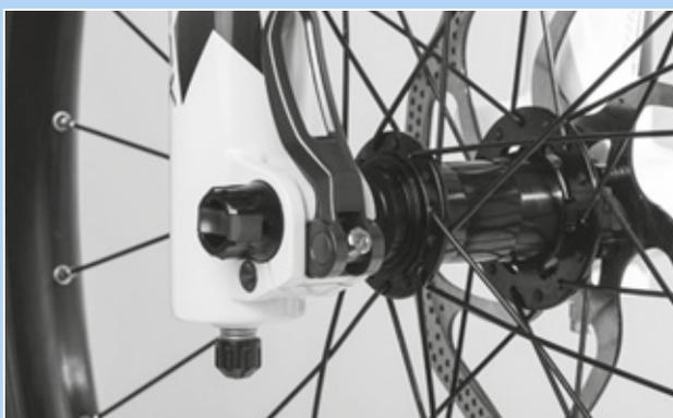
Figura 73: Posición perfecta de la palanca tensora
