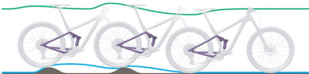
Figura 223: Descompresión demasiado lenta del amortiguador de la horquilla trasera
