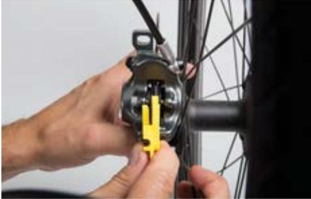
Figura 164: Comprobación de la almohadilla de freno montada con ayuda del seguro de transporte
