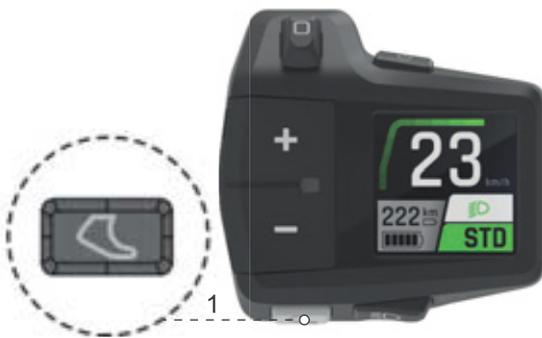
Figura 146: Posición del botón de ayuda para el desplazamiento
