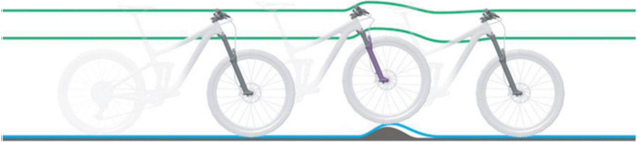
Figura 211: Amortiguación de la horquilla de suspensión demasiado dura en caso de irregularidades
