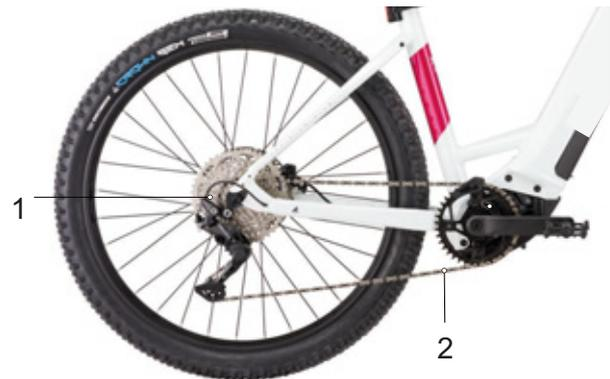
Figura 31: Esquema de la transmisión por cadena con cambio de cadena
