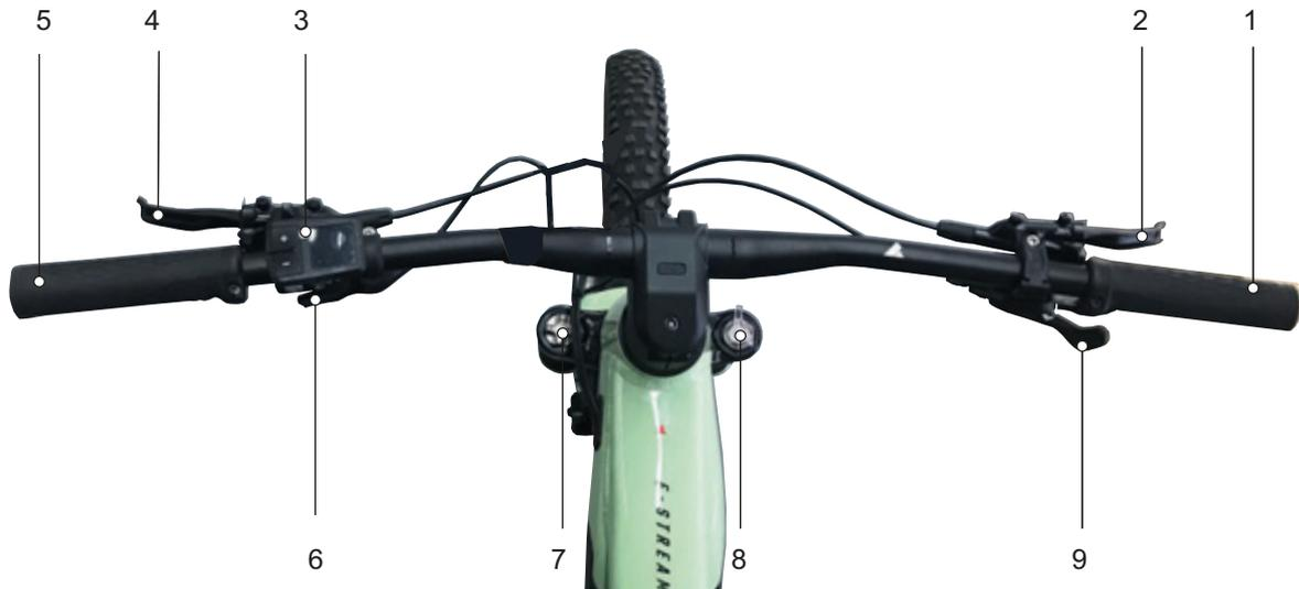
Figura 36: Vista detallada del manillar con ordenador de a bordo FIT Remote LCD, ejemplo
