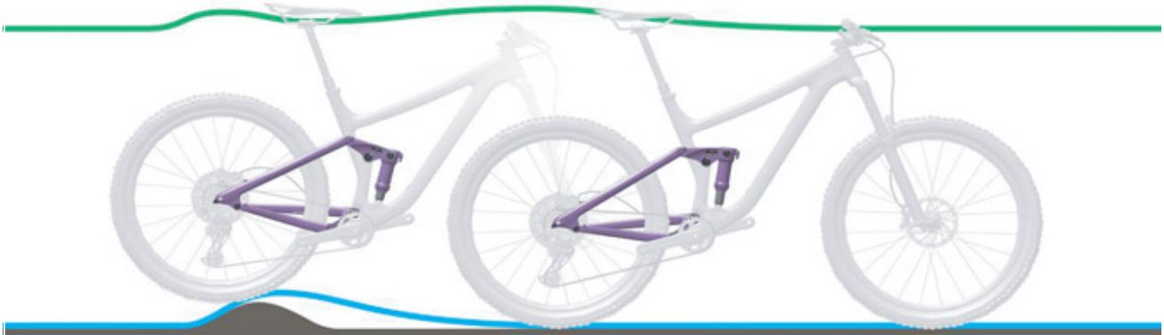
Figura 219: Amortiguación del amortiguador de la horquilla trasera demasiado dura en caso de irregularidades
