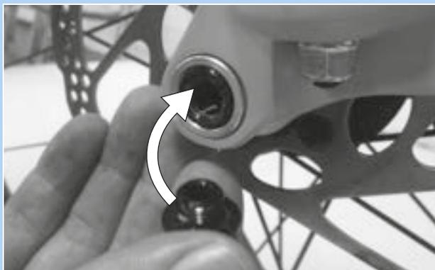
Figura 67: Insertar el tornillo de seguridad
