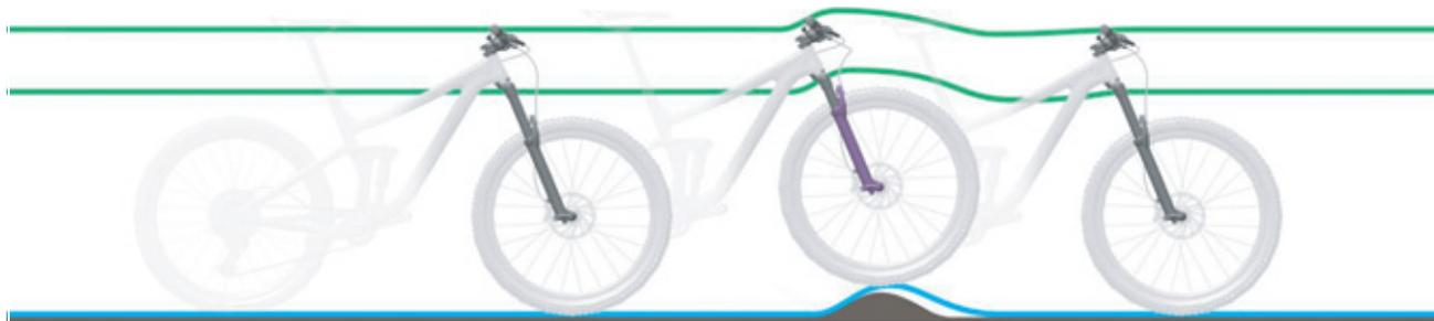
Figura 203: Amortiguación de la horquilla de suspensión demasiado dura en caso de irregularidades
