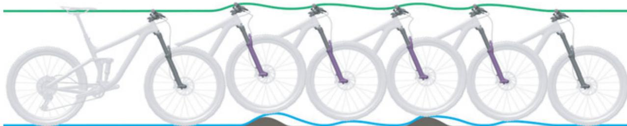
Figura 205: Descompresión demasiado rápida de la horquilla de suspensión
