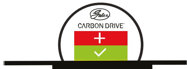
Figura 186: Ejemplo: En el borde amarillo inferior, por ello reducir la tensión de correa ligeramente
