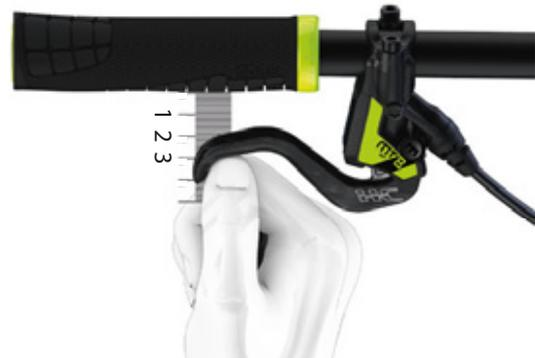
Figura 121: Posicionamiento del freno de mano
