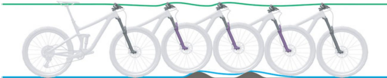
Figura 199: Descompresión demasiado lenta de la horquilla de suspensión
