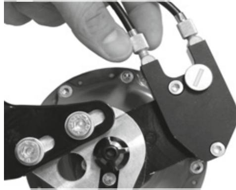
Figura 190: Las versiones de bujes ROHLOFF con activación de cambio externa tienen los dispositivos de ajuste de tensión en la caja de cables que se encuentra en el lado izquierdo
