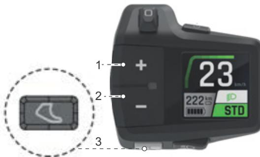
Figura 148: Posición del botón + (1), del botón - (2) y del botón de ayuda para el desplazamiento (3)
