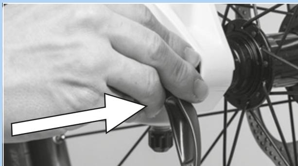
Figura 76: Inserción del cierre rápido en la dirección de la flecha
