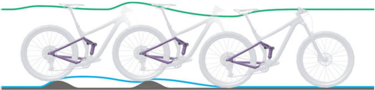
Figura 215: Descompresión demasiado lenta del amortiguador de la horquilla trasera
