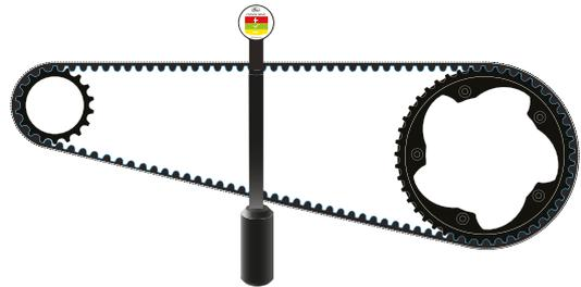
Figura 184: Varilla de medición enganchada
