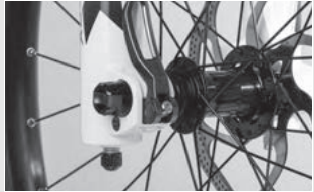
Figura 49: Corretta posizione della leva di serraggio
