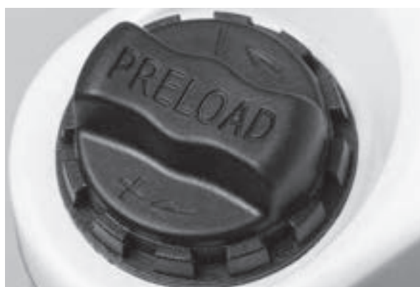
Figura 70: Manopola di regolazione dell'escursione negativa della sospensione sulla corona della forcella ammortizzata
