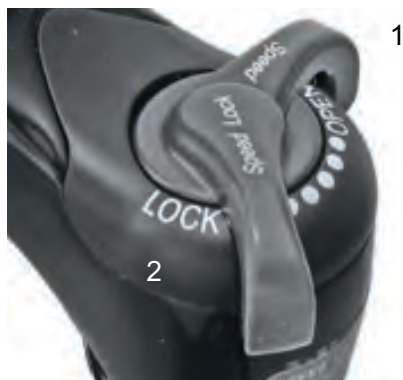
Figura 87: Regolatore dello stadio di pressione Suntour con posizioni OPEN (1) e LOCK (2)
