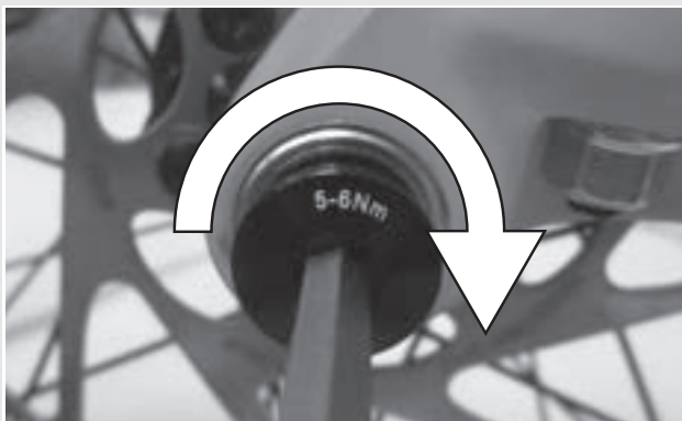
Figura 42: Serraggio della vite di sicurezza
