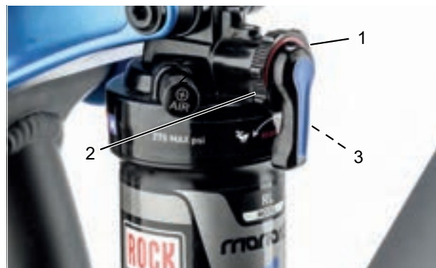
Figura 88: Regolazione della rigidità dell'ammortizzatore a stadi di trazione con la manopola di regolazione (1) dell'ammortizzatore del carro posteriore
