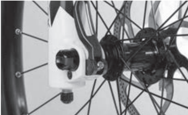
Figura 93: Regolazione della forza di serraggio del bloccaggio rapido
