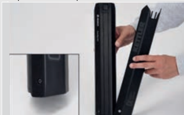
Figura 34: Applicazione della copertura della batteria sulla batteria
