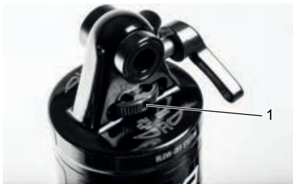
Figura 74: Regolatore del rebound Suntour (1) sull'ammortizzatore del carro posteriore
