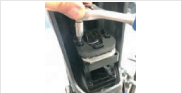
Figura 26: Svitamento delle viti del portabatteria
