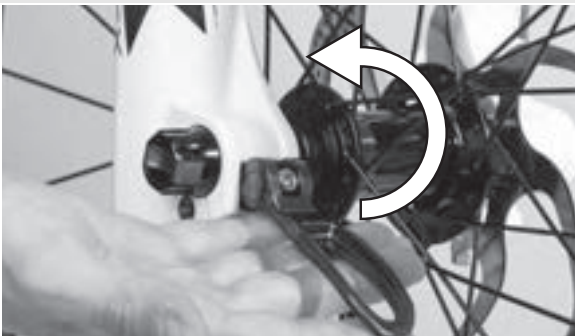
Figura 48: Bloccaggio della leva
