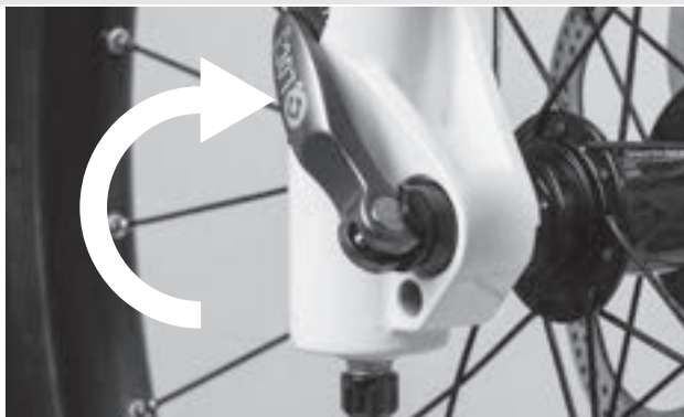
Figura 54: Chiusura del bloccaggio rapido
