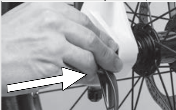
Figura 52: Inserimento del bloccaggio rapido
