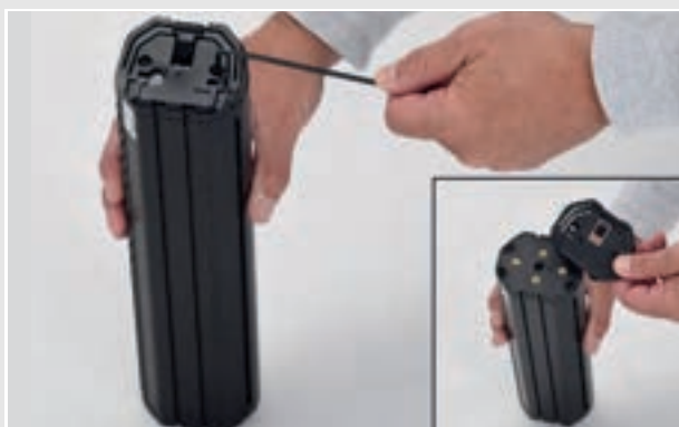
Figura 35: Smontaggio dell'interfaccia superiore
