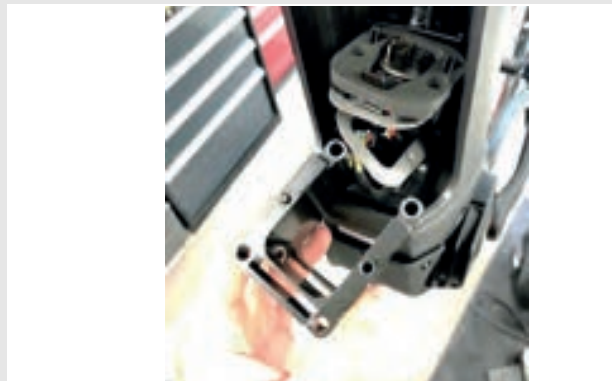
Figura 29: Estrazione dell'adattatore PowerTube
