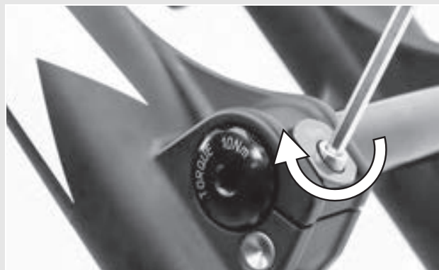
Figura 44: Serraggio del morsetto di sicurezza
