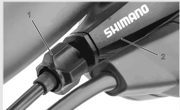
Figura 95: Boccola di regolazione (1) del cambio azionato da cavo singolo con scatola della leva del cambio (2), esempio
