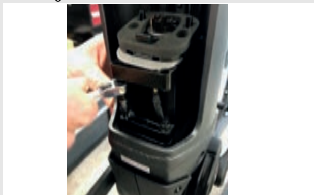
Figura 27: Rimozione delle viti a testa esagonale da 4 mm
