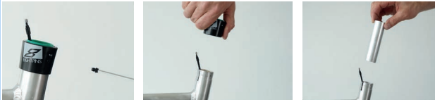
Abbildung 407: Außenhülse und Gleitbuchse ausbauen
