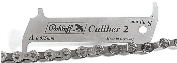
Abbildung 372: Beispiel Messlehre SRAM
