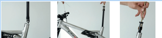
Abbildung 427: Kartusche Ventildeckel befestigen
