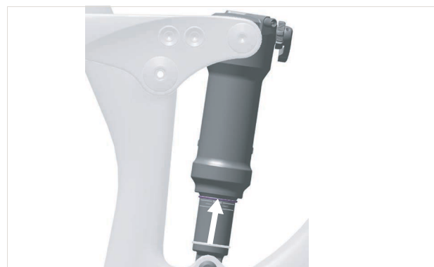
Abbildung 249: O-Ring am Hinterbau-Dämpfer verschieben
