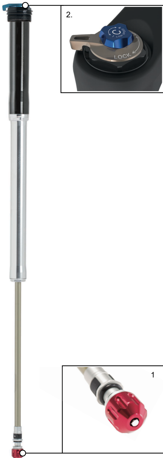
Abbildung 36: Bedienelemente des NLO
