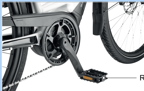
Abbildung 193: R-Pedal im rechten Kurbelarm
