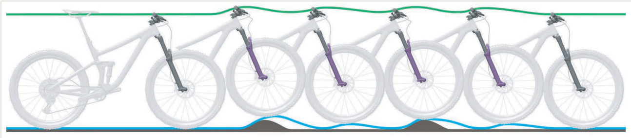
Abbildung 484: Zu schnelles Ausfedern der Federgabel
