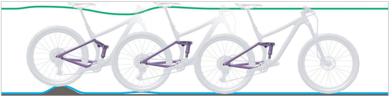
Abbildung 494: Zu schnelles Ausfedern des Hinterbau-Dämpfers
