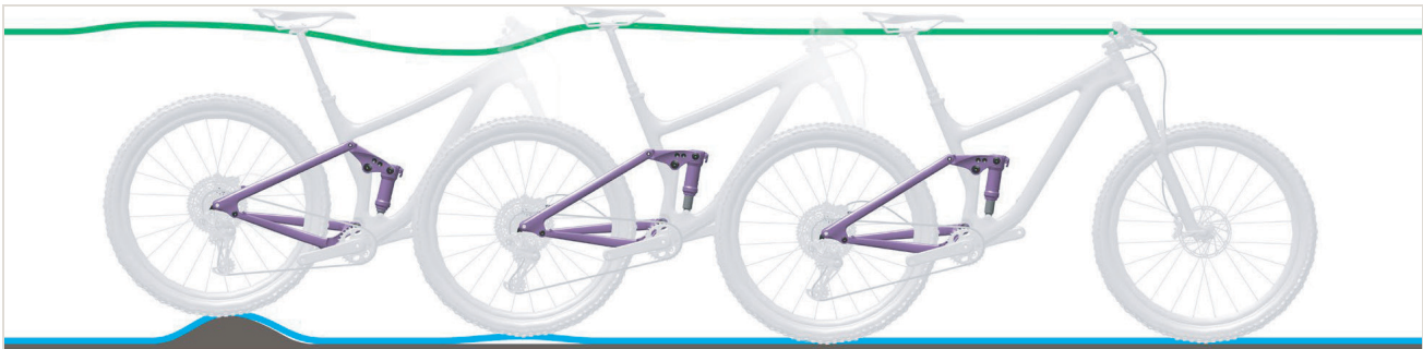
Abbildung 502: Zu schnelles Ausfedern des Hinterbau-Dämpfers
