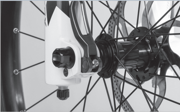
Abbildung 181: Perfekte Lage des Spannhebels
