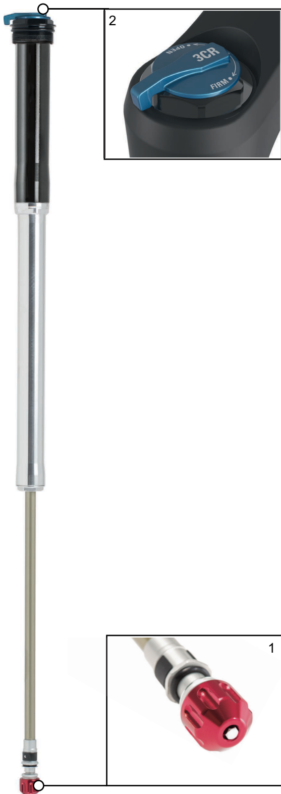
Abbildung 30: Bedienelemente des 3CR-PCS
