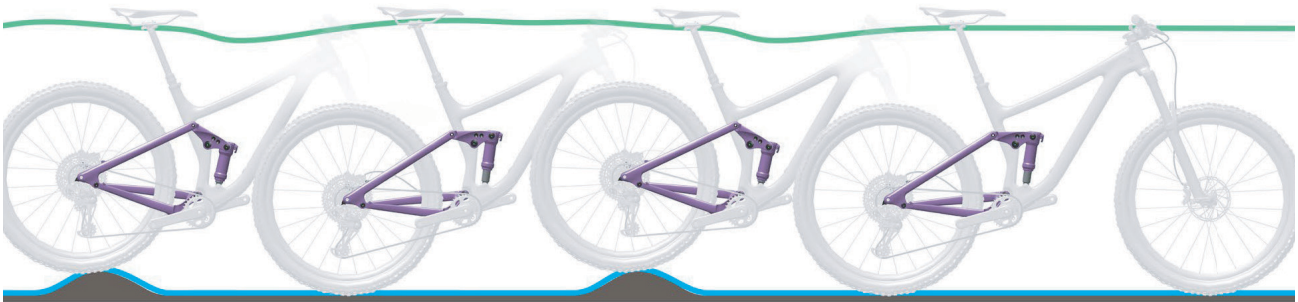
Abbildung 9: Optimales Fahrverhalten des Hinterbau-Dämpfers
