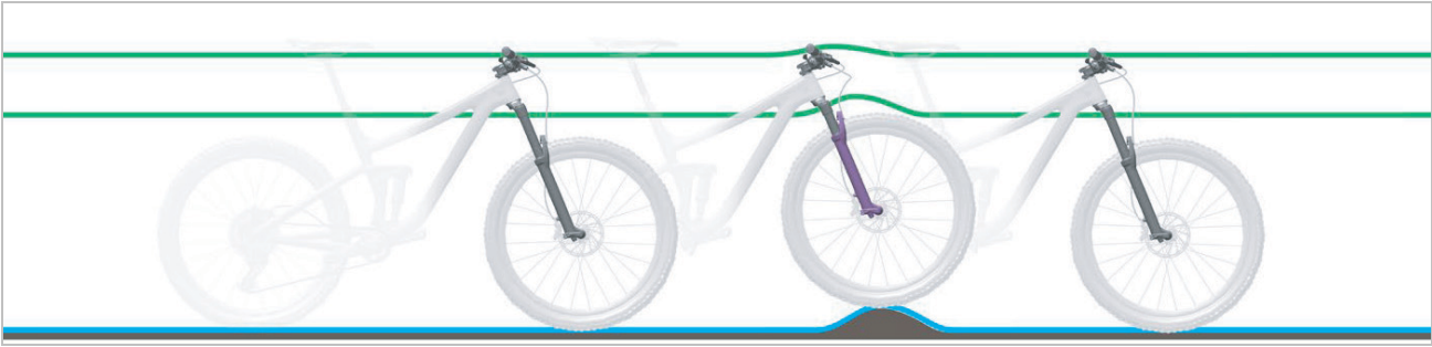
Abbildung 25: Optimales Fahrverhalten der Federgabel bei Unebenheiten
