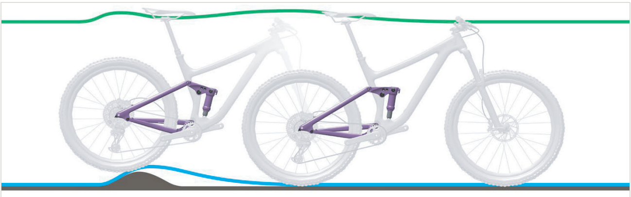
Abbildung 508: Zu harte Dämpfung des Hinterbau-Dämpfers bei Unebenheiten
