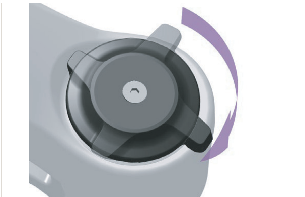
Abbildung 481: Druckstufen-Einsteller härter einstellen
