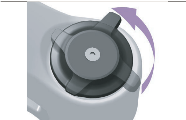
Abbildung 483: Druckstufen-Einsteller weicher einstellen
