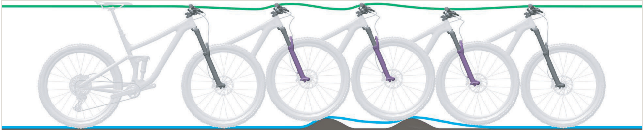
Abbildung 486: Zu langsames Ausfedern der Federgabel
