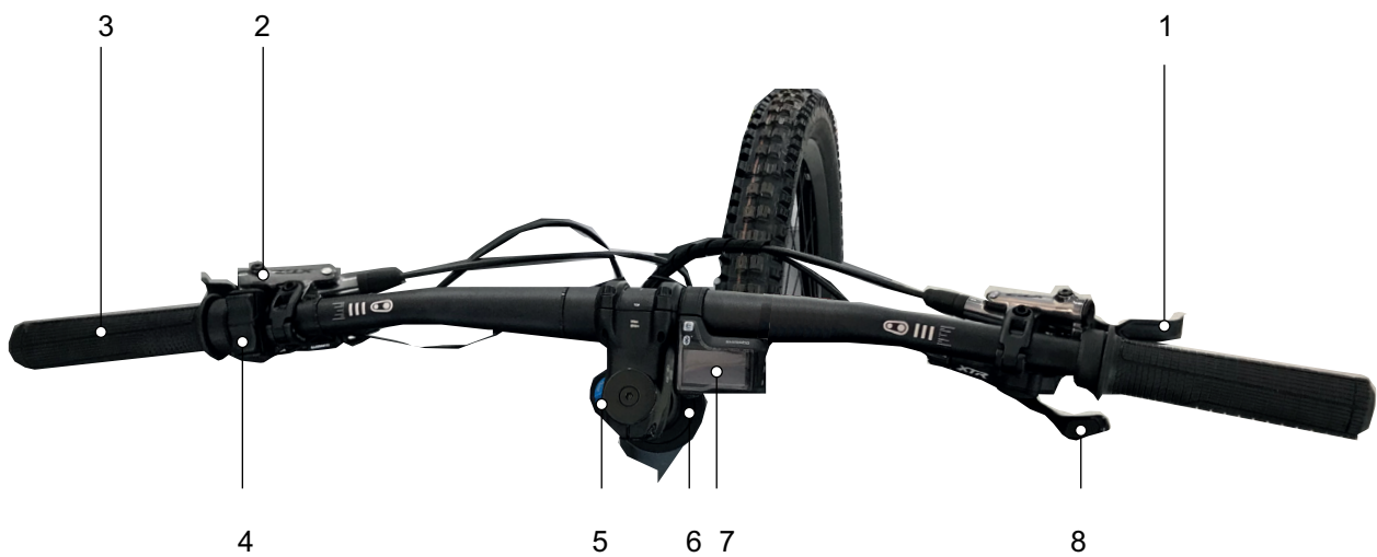
Abbildung 151: Detailansicht Lenker mit SHIMANO SC-E800 Bordcomputer, Beispiel
