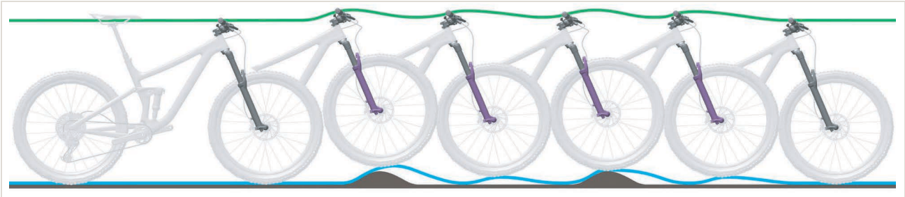
Abbildung 476: Zu schnelles Ausfedern der Federgabel
