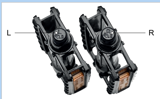
Abbildung 191: Beispiel Markierung von Pedalen
