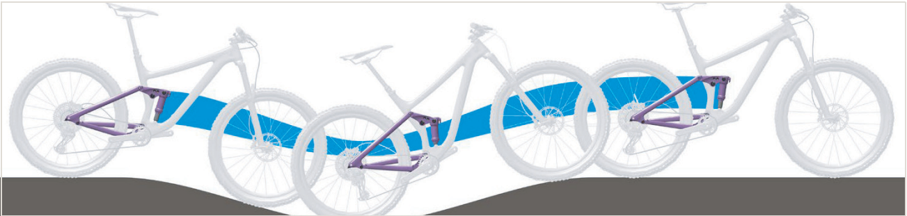
Abbildung 506: Zu weiche Federung des Hinterbau-Dämpfers am Berg
