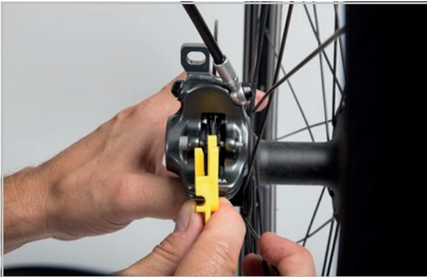
Abbildung 367: Bremsbelag im eingebauten Zustand mithilfe der Transportsicherung prüfen
