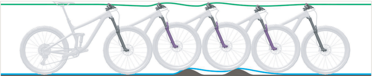
Abbildung 478: Zu langsames Ausfedern der Federgabel
