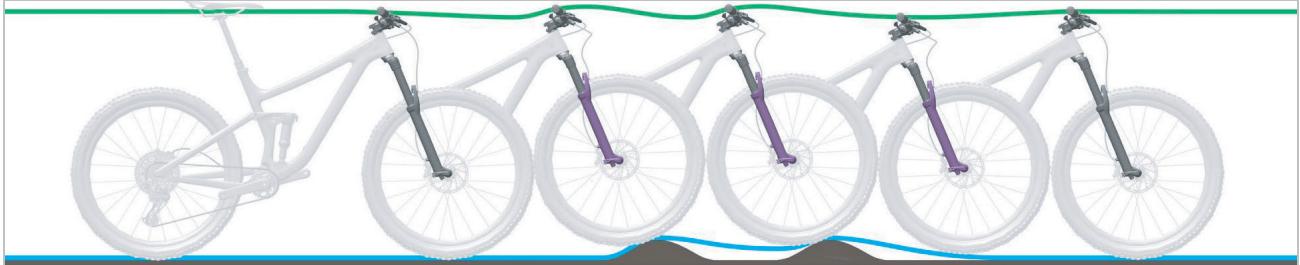
Abbildung 472: Zu langsames Ausfedern der Federgabel
