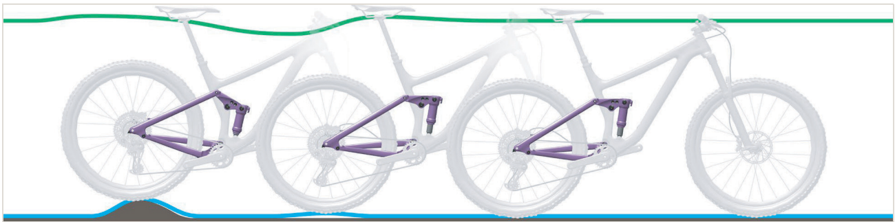
Abbildung 510: Zu schnelles Ausfedern des Hinterbau-Dämpfers
