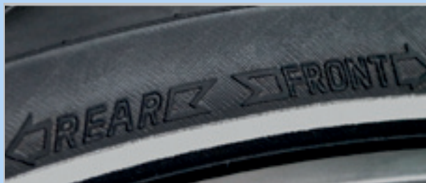
Abbildung 172: Laufrichtungspfeil auf MTB-Reifen
