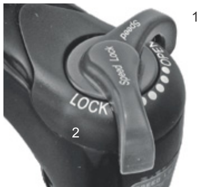
Afbeelding 74: Suntour drukdemperafsteller met de standen OPEN (1) en LOCK (2)
