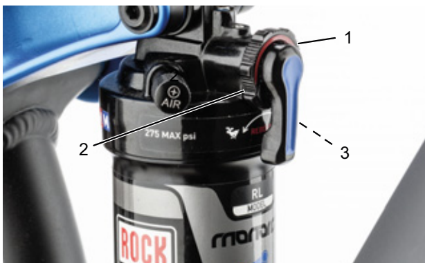
Afbeelding 80: Hardheid van de trekdemper afstellen met het afstelwiel (1) van de achterbouwdemper
