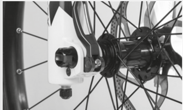
Afbeelding 85: Spankracht van de snelspanner afstellen
