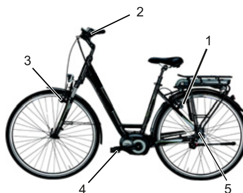
Afbeelding 12: Remsysteem met terugtraprem, voorbeeld
