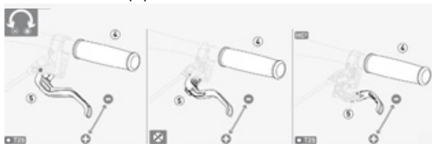
Afbeelding 56: Grijpafstand remhendel Magura schijfrem afstellen
