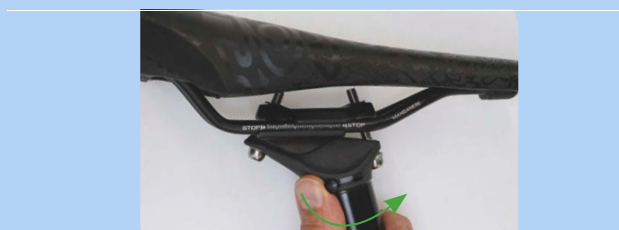
Rysunek 452: Otwieranie mechanizmu regulacji wysokości
