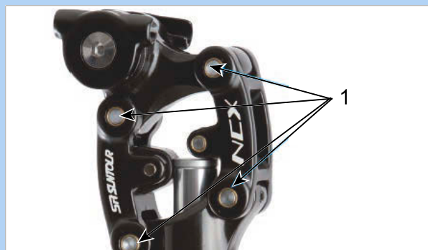
Rysunek 400: Punkty smarowania amortyzowanej sztycy podsiodłowej SR SUNTOUR
