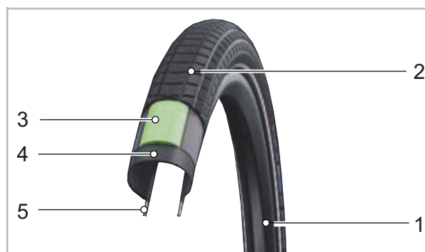
Rysunek 43: Budowa opony otwartej
