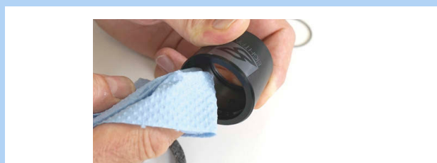
Rysunek 413: Czyszczenie tulei zewnętrznej
