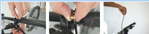
Rysunek 440: Odkręcanie zdalnego sterowania
