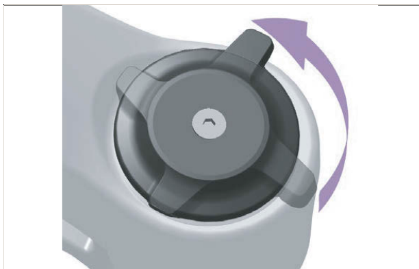
Rysunek 484: Wyregulować nastawnik dobicia tak, aby amortyzator był bardziej miękki
