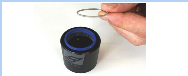
Rysunek 445: Wyciągnięty pierścień sprężysty
