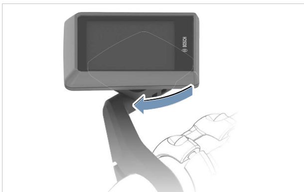
Rysunek 269: Obracanie ekranu w kierunku zgodnym z ruchem wskazówek zegara
