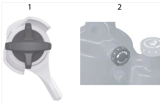
Rysunek 512: Nastawnik odbicia Float DPS (1) i Float X (2)
