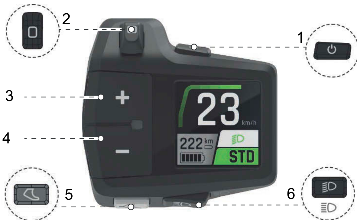
Rysunek 147: Zestawienie opcji panelu obsługi FIT LED Remote
