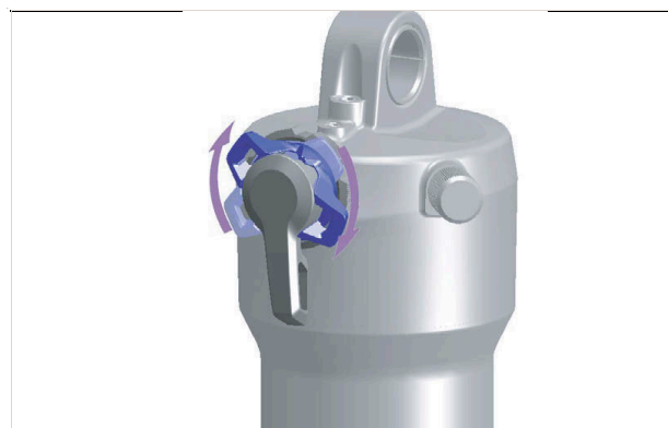
Rysunek 314: Wyregulować nastawnik dobiecia tak, aby amortyzator był bardziej twardy
