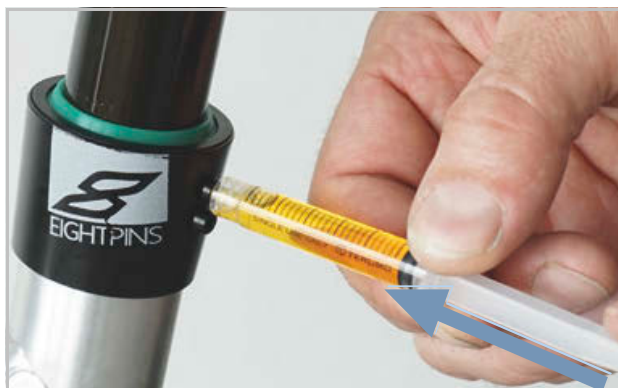
Rysunek 365: Smarowanie sztycy podsiodłowej EIGHTPINS
