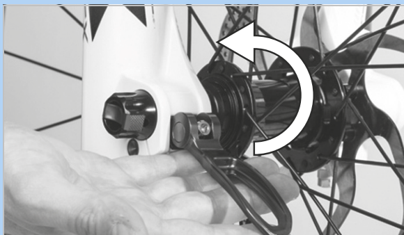
Rysunek 179: Docisnąć dźwignia zacisku szybko mocującego zgodnie z kierunkiem strzałki
