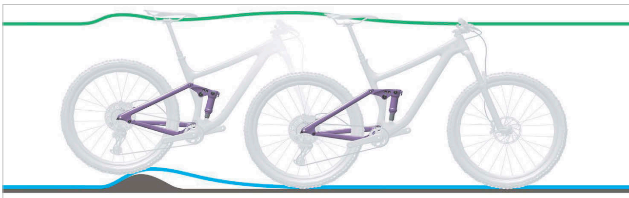
Rysunek 501: Zbyt twarde tłumienie tylnego amortyzatora na nierównościach
