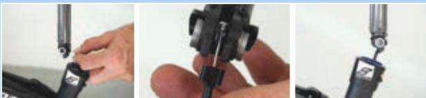
Rysunek 459: Zaczepianie i wsuwanie sztycy podsiodłowej
