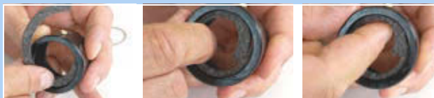
Rysunek 414: Wkładanie pierścienia filcowego
