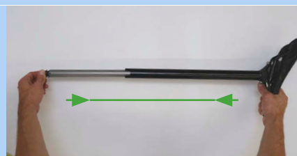
Rysunek 456: Zsuwanie sztycy podsiodłowej
