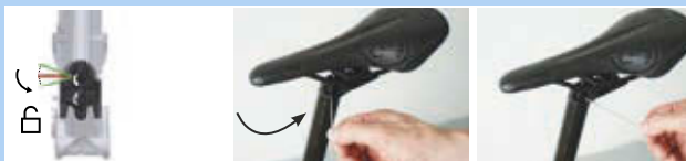
Rysunek 401: Ustawianie mechanizmu regulacji wysokości w pozycji „otwartej”
