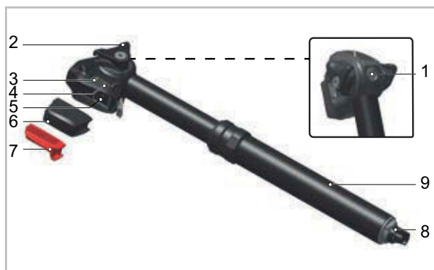
Rysunek 70: Budowa sztycy podsiodłowej ROCKSHOX Reverb AXS
