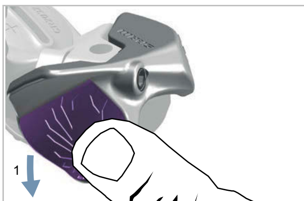
Rysunek 352: Przełączanie w górę (1)
