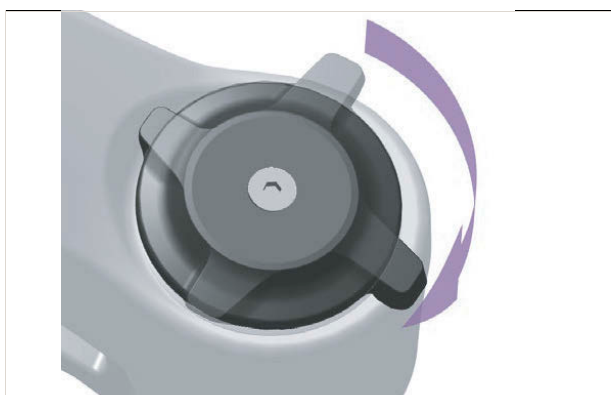
Rysunek 482: Wyregulować nastawnik dobicia tak, aby amortyzator był bardziej twardy
