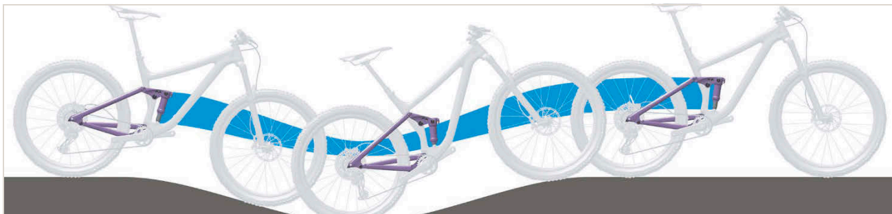
Rysunek 515: Zbyt miękkie amortyzowanie tylnego amortyzatora na wzniesieniu
