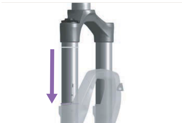
Rysunek 234: Przesuwanie pierścienia o-ring widelca amortyzowanego
