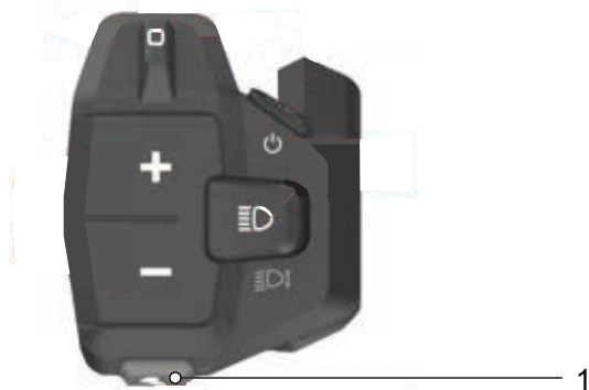
Rysunek 333: Położenie przycisku mechanizmu wspomagającego pchanie
