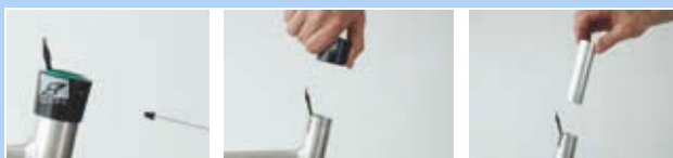
Rysunek 409: Demontaż tulei zewnętrznej i tulei ślizgowej
