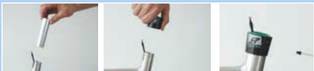
Rysunek 425: Montaż tulei ślizgowej i tulei zewnętrznej
