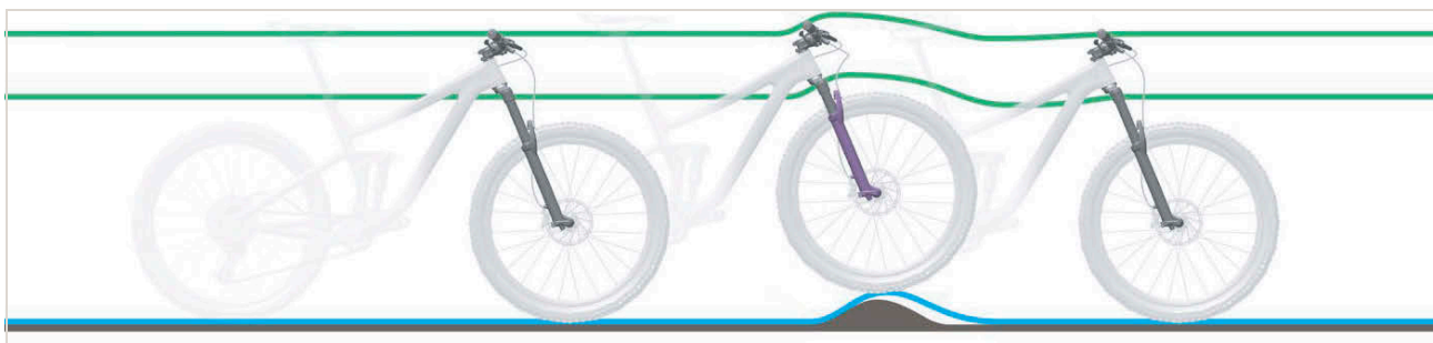
Rysunek 492: Zbyt twarde tłumienie widelca amortyzowanego na nierównościach
