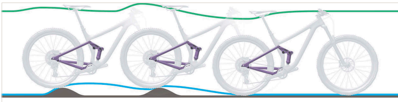
Rysunek 497: Zbyt wolne rozprężanie się tylnego amortyzatora
