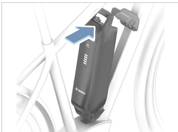
Rysunek 300: Zakładanie akumulatora PowerPack ruchem do góry
