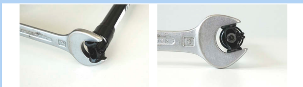
Rysunek 422: Zabezpieczenie przed przekręceniem się
