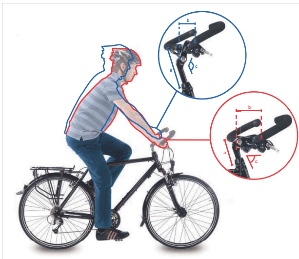
Rysunek 214: Pozycja roweru miejskiego (niebieski) i trekkingowego (czerwony) dzięki regulacji kąta nachylenia
