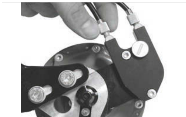
Rysunek 395: Wersje piast ROHLOFF z zewnętrznym sterowaniem mechanizmu zmiany biegów mają regulator linki na puszcze, która znajduje się po lewej stronie
