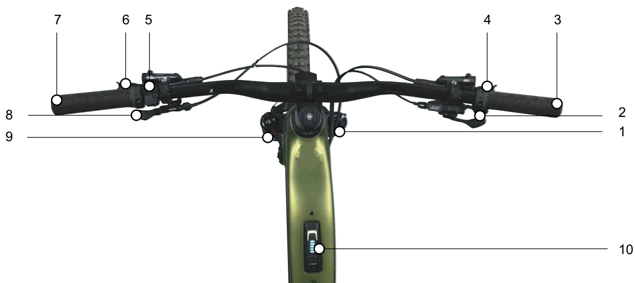
Rysunek 121: Widok szczegółowy kierownicy z komputerem pokładowym System Controller firmy BOSCH i kontrolerem Mini Remote, przykład
