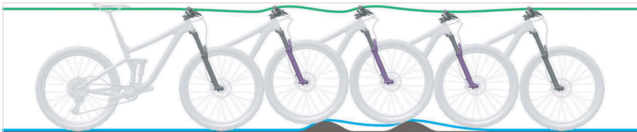
Rysunek 479: Zbyt wolne rozprężanie widelca amortyzowanego
