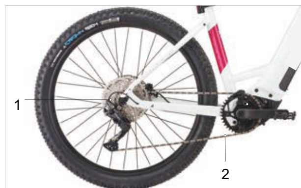
Rysunek 73: Schemat napędu łańcuchowego z przerzutką
