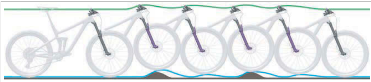
Rysunek 471: Zbyt szybkie rozprężanie widelca amortyzowanego
