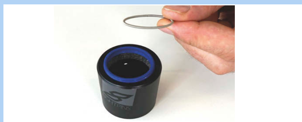
Rysunek 410: Wyciągnięty pierścień sprężysty
