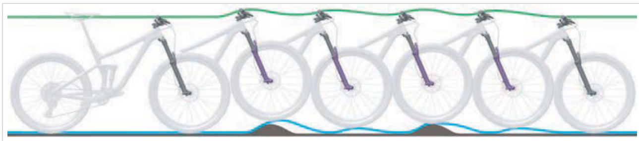
Rysunek 485: Zbyt szybkie rozprężanie widelca amortyzowanego
