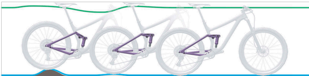
Rysunek 495: Zbyt szybkie rozprężanie się tylnego amortyzatora
