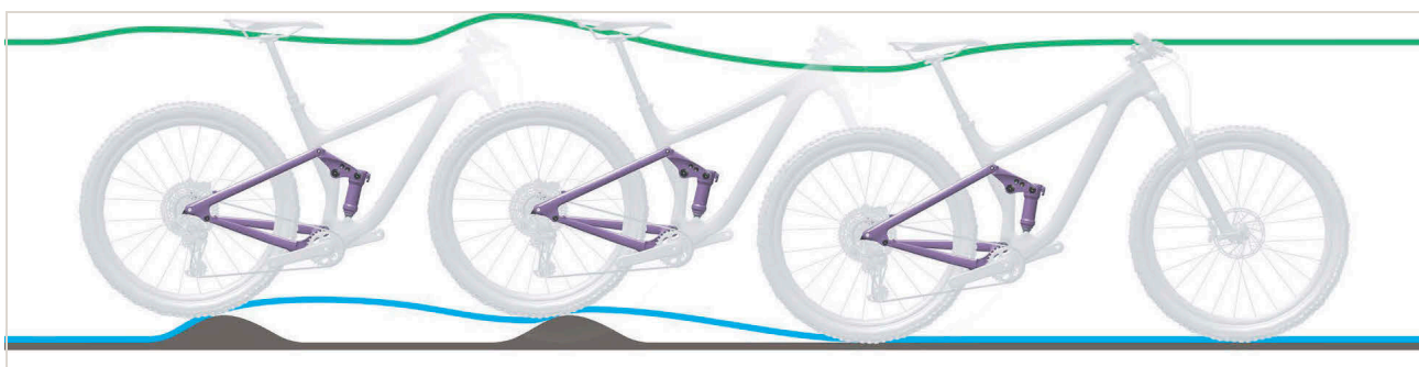
Rysunek 513: Zbyt wolne rozprężanie się tylnego amortyzatora
