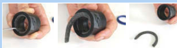
Rysunek 412: Wyciąganie pierścienia filcowego
