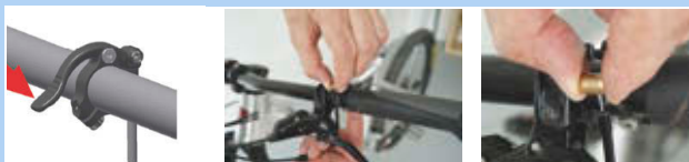
Rysunek 403: Demontaż wkładu
