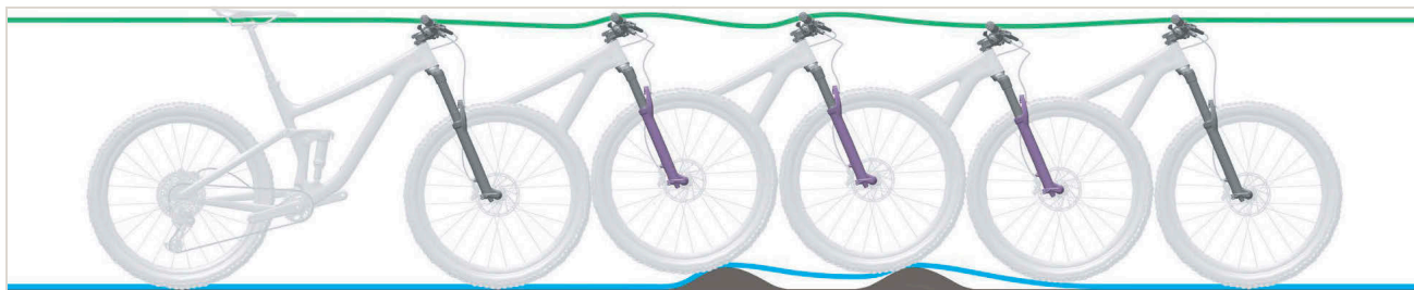
Rysunek 487: Zbyt wolne rozprężanie widelca amortyzowanego
