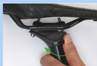
Rysunek 457: Zamykanie mechanizmu regulacji wysokości
