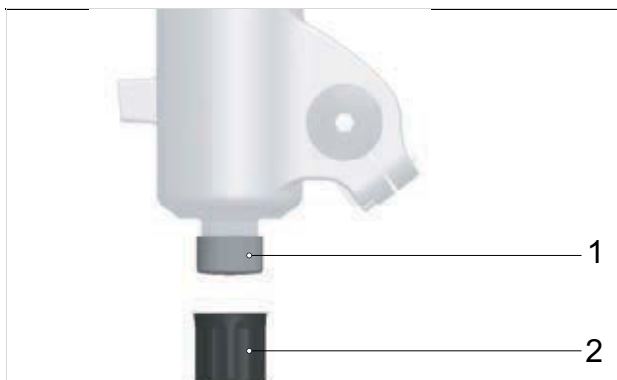
Rysunek 488: Nastawnik odbicia (widelca) (1) pod kapturkiem (2) widelca FOX
