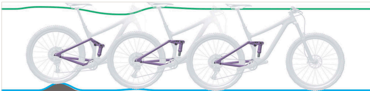
Rysunek 511: Zbyt szybkie rozprężanie się tylnego amortyzatora
