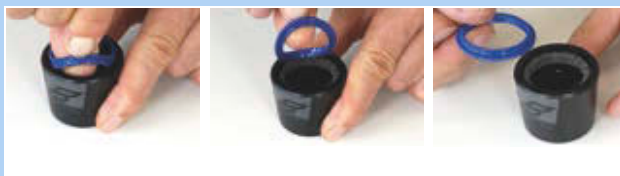
Rysunek 446: Wyciąganie zgarniacza
