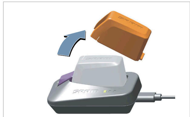
Rysunek 530: Zdejmowanie osłony akumulatora
