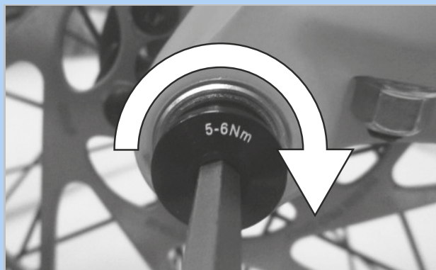
Rysunek 175: Sposób dokręcania śruby zabezpieczającej
