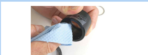
Rysunek 448: Czyszczenie tulei zewnętrznej
