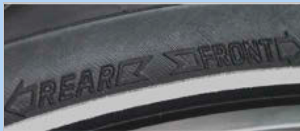
Rysunek 171: Strzałka kierunku obrotów na oponach MTB
