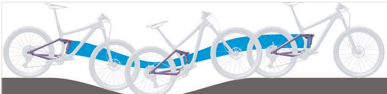
Rysunek 499: Zbyt miękkie amortyzowanie tylnego amortyzatora na wzniesieniu
