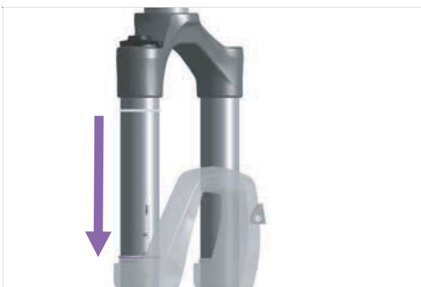
Rysunek 237: Przesuwanie pierścienia o-ring na widelcu amortyzowanym
