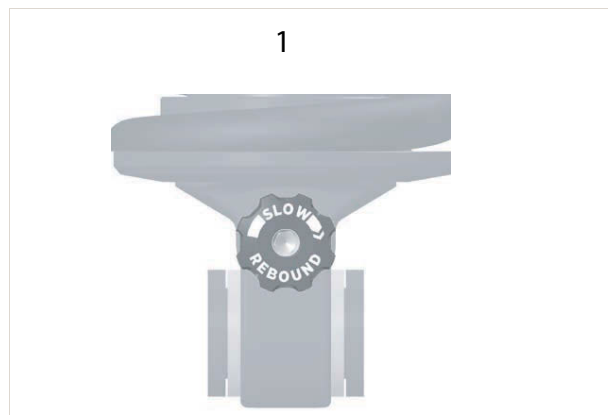
Rysunek 257: Nastawnik odbicia amortyzatora Float DHX (1)
