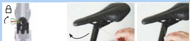
Rysunek 438: Zamykanie mechanizmu regulacji wysokości
