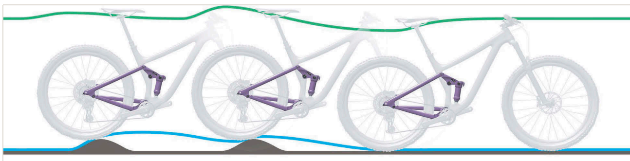
Rysunek 505: Zbyt wolne rozprężanie się tylnego amortyzatora
