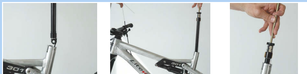
Rysunek 429: Mocowanie nakrętki zaworu wkładu
