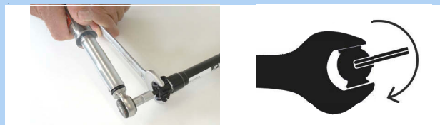
Rysunek 423: Regulacja zgodnie z ruchem wskazówek zegara
