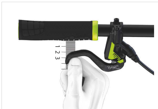
Rysunek 221: Ustawienie hamulca ręcznego
