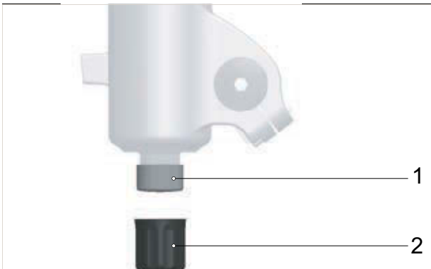
Rysunek 253: Nastawnik odbicia (widelca) (1) pod kapturkiem (2) widelca FOX
