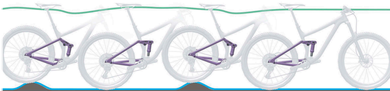
Rysunek 9: Optymalne działanie tylnego amortyzatora
