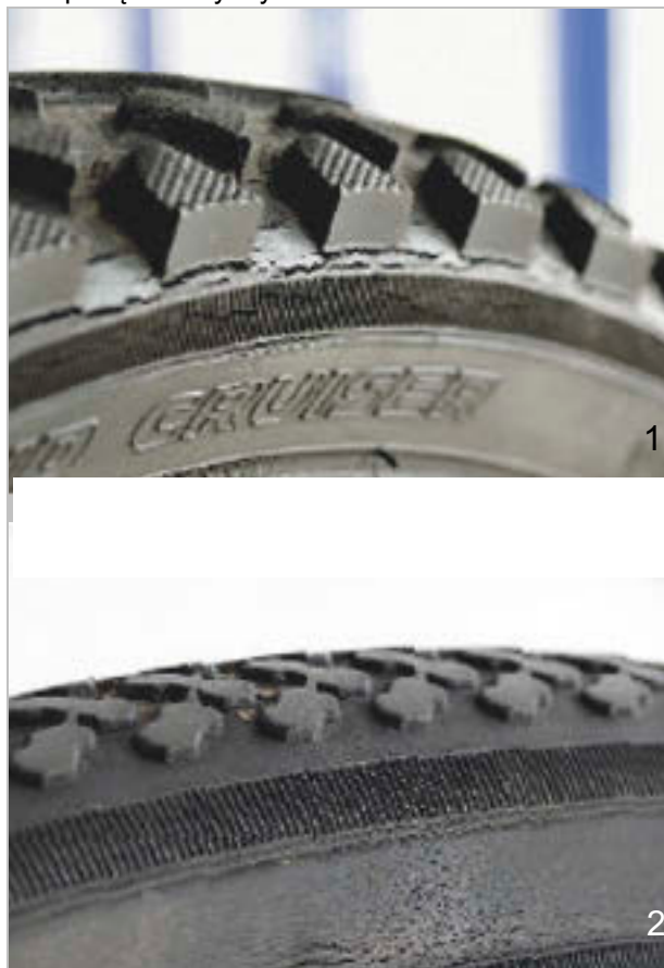
Rysunek 368: Przykłady pęknięć zmęczeniowych (1) i w wyniku starzenia się (2)
